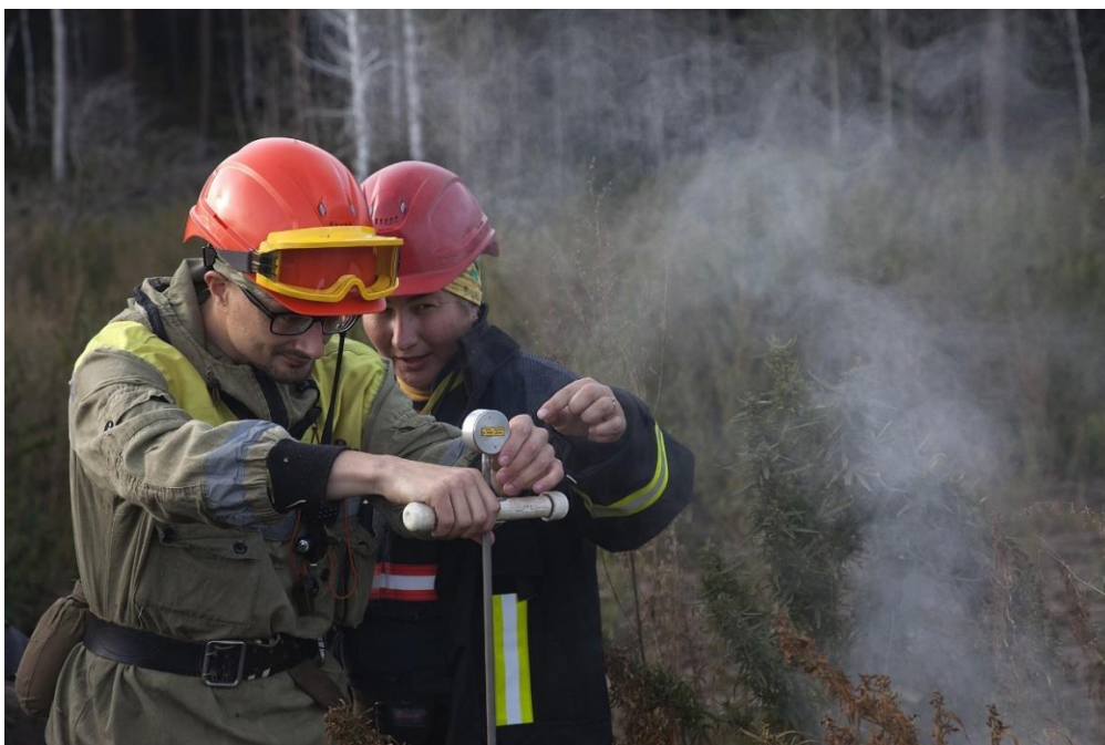
Рис. 25. Применение на торфяном пожаре для оценки глубины очагов щупа-термометра для силоса и торфа, произведенного заводом «Замер»
