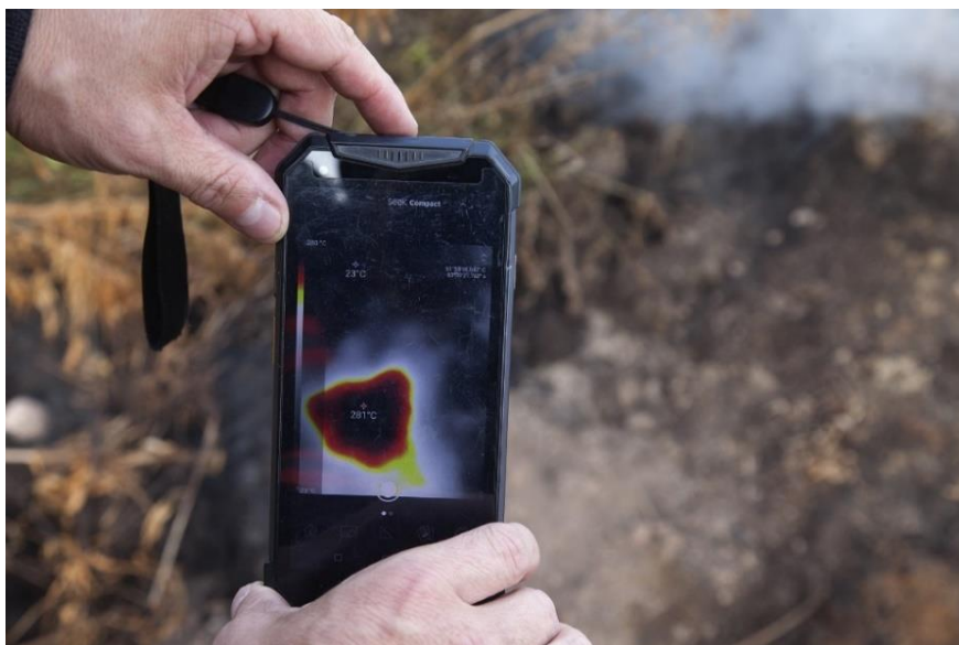
Рис. 17. Обследование торфяного очага при помощи ручного тепловизора, вставляемого в разъем смартфона. Экран смартфона со специальным приложением становится рабочим экраном и органом управления тепловизором. А сама тепловая камера реализована как отдельное небольшое устройство с Type-C разъемом
