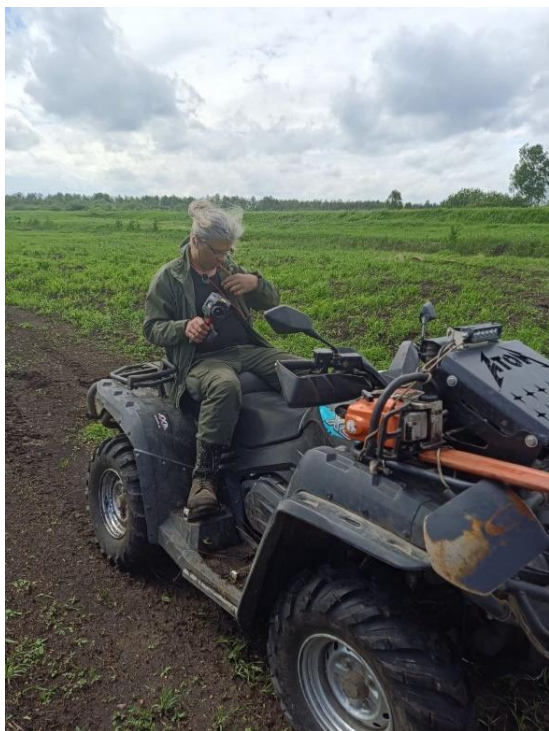
Рис. 20. Подготовка оператора с промышленным ручным тепловизором к обследованию с мотовездехода. Производится калибровка и настройка прибора, наушники используются для оповещения оператора об обнаружении температуры, выше пороговой
