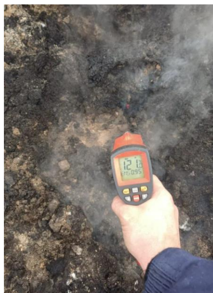
Рис. 22. Применение инфракрасного пирометра для детального обследования глубоких торфяных очагов
