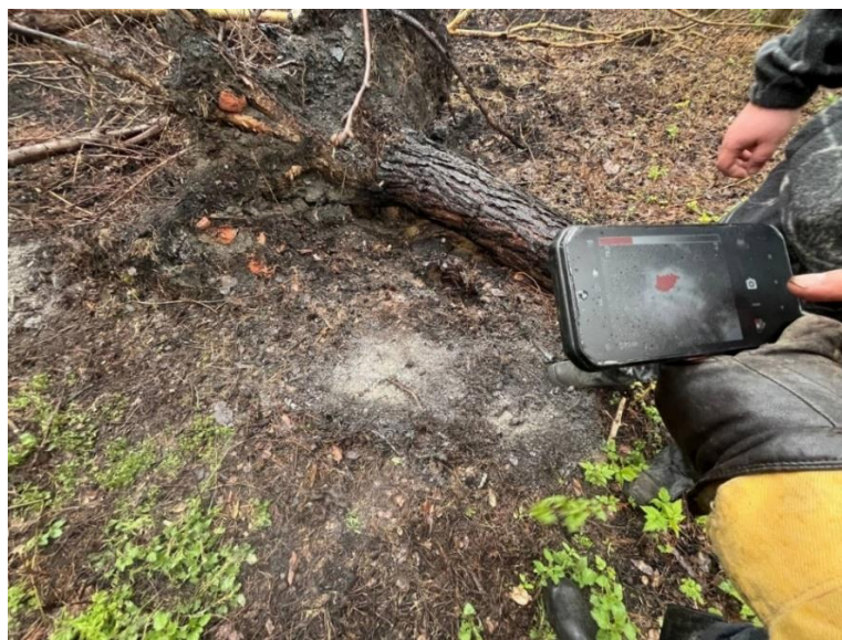
Рис. 19. Обнаружение скрытого (подземного) очага тления тепловизором
