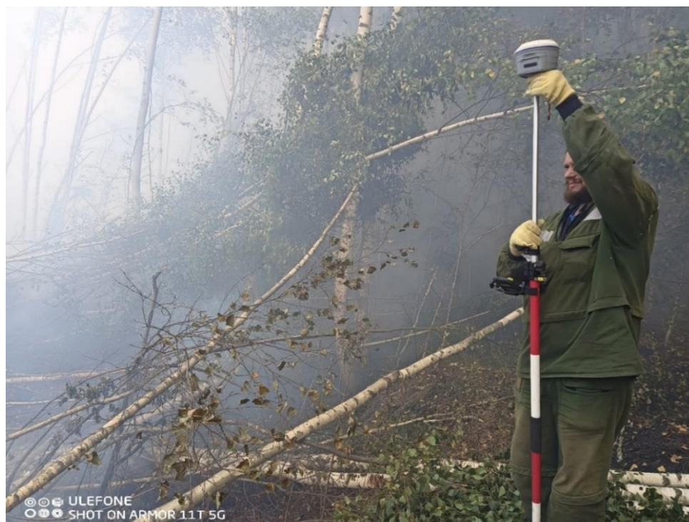
Рис. 29. Измерения рельефа на крупном многоочаговом торфяном пожаре для организации его тушения подтоплением
