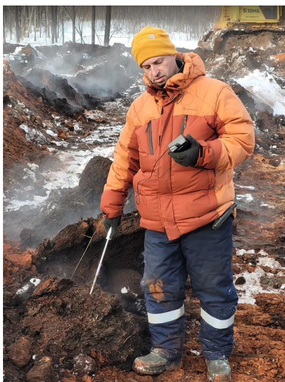
Рис. 34. Использование влагомера на тушении зимнего торфяного пожара
