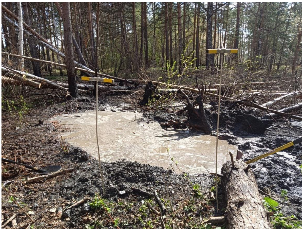
Рис. 27. Потушенный торфяной очаг и щупы-термометры, оставленные на несколько минут на различных глубинах для более точного замера оставшейся температуры
