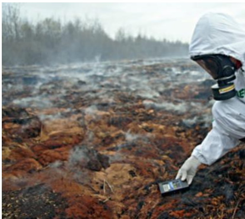
Рис. 40. Замеры уровней мощности дозы гамма-излучения на крупных торфяных пожарах в радиационно-загрязненной местности
