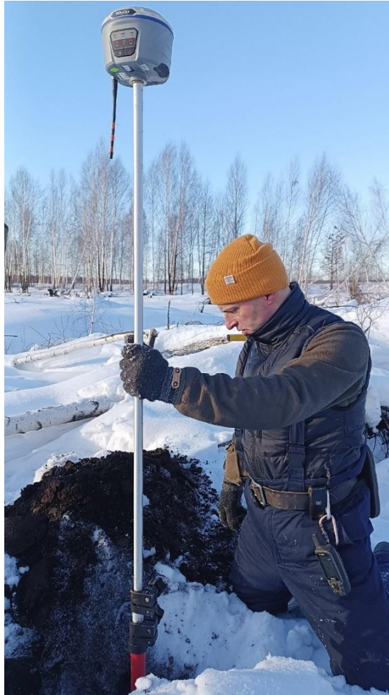
Рис. 30. Использование спутникового геодезического оборудования при определении глубин зимних торфяных пожаров и для оценки возможности их подтопления весной
