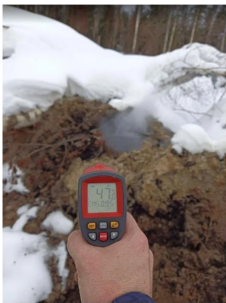
Рис. 21. Применение инфракрасного пирометра для обследования зимних торфяных пожаров
