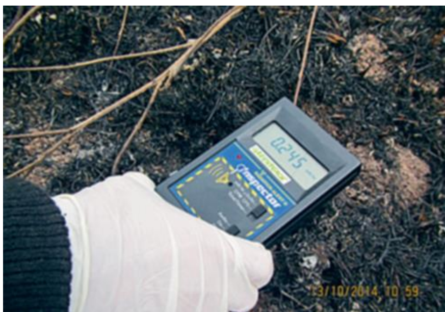
Рис. 39. Использование дозиметра на торфяном пожаре для определения мощности гамма-излучения у поверхности почвы
