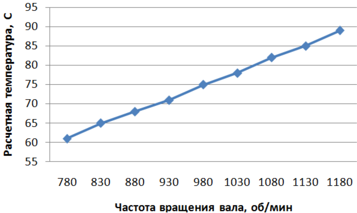
Рис. 4. График зависимости температуры подшипников от оборотов ротора
