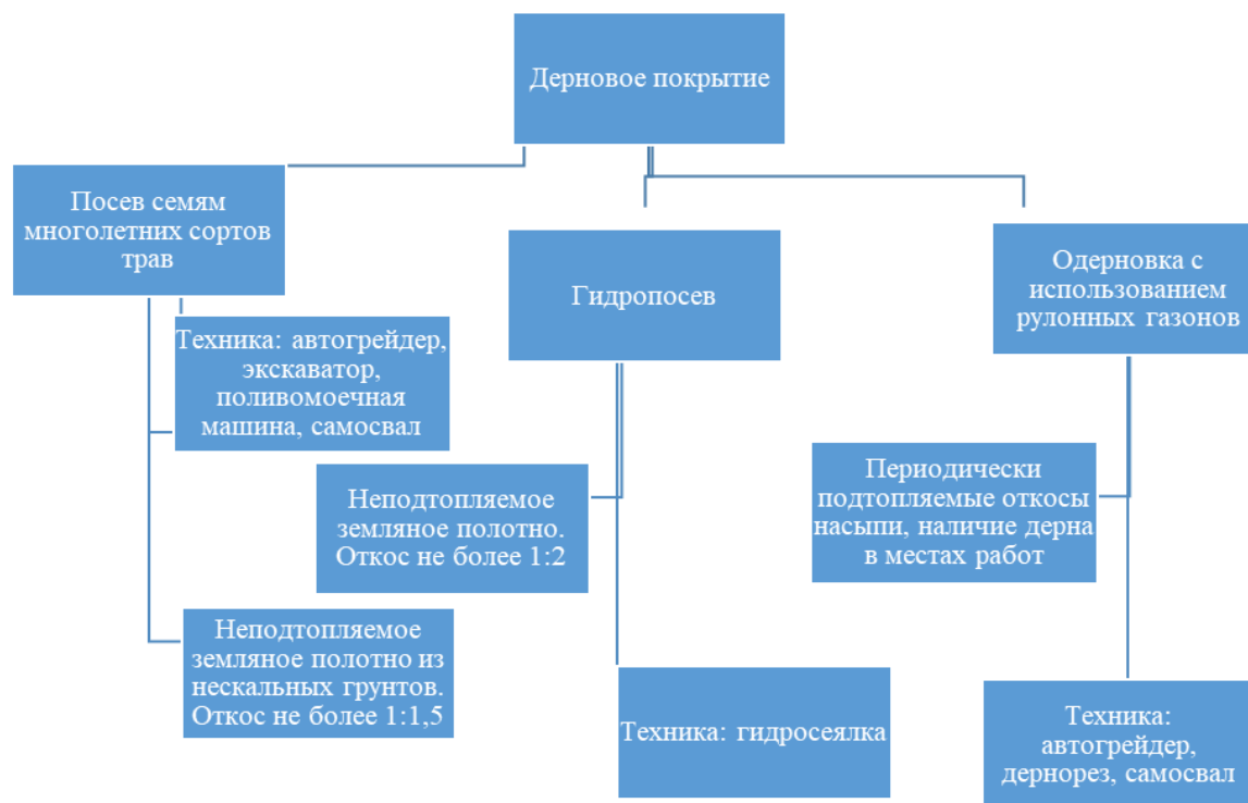
Рис. 1. Схема способов укрепления откосов дерновым покрытием
