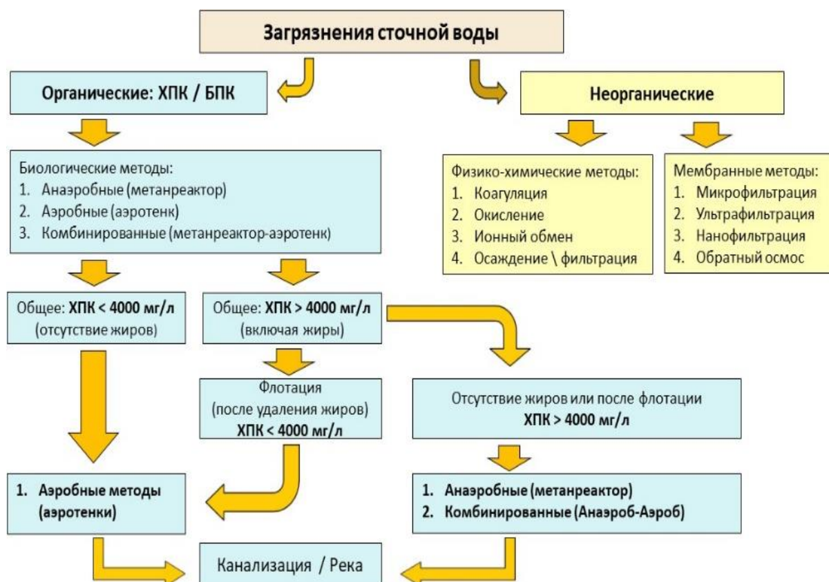
Упрощенная схема выбора технологии очистки сточных вод
