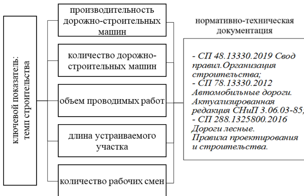
Схема определения влияющих параметров на темп строительства
