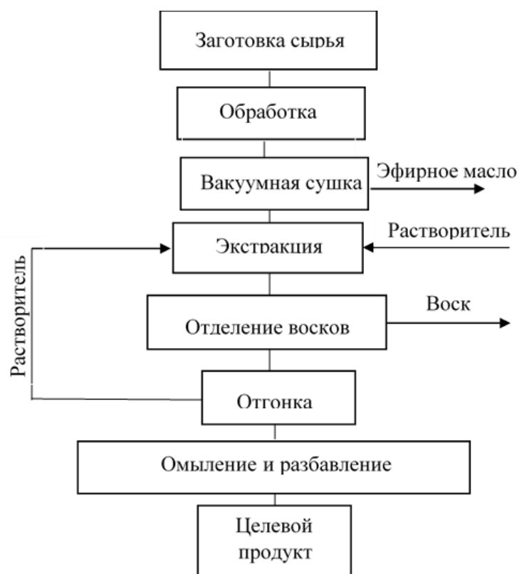
Рис. 1. Принципиальная схема переработки хвойной зелени
