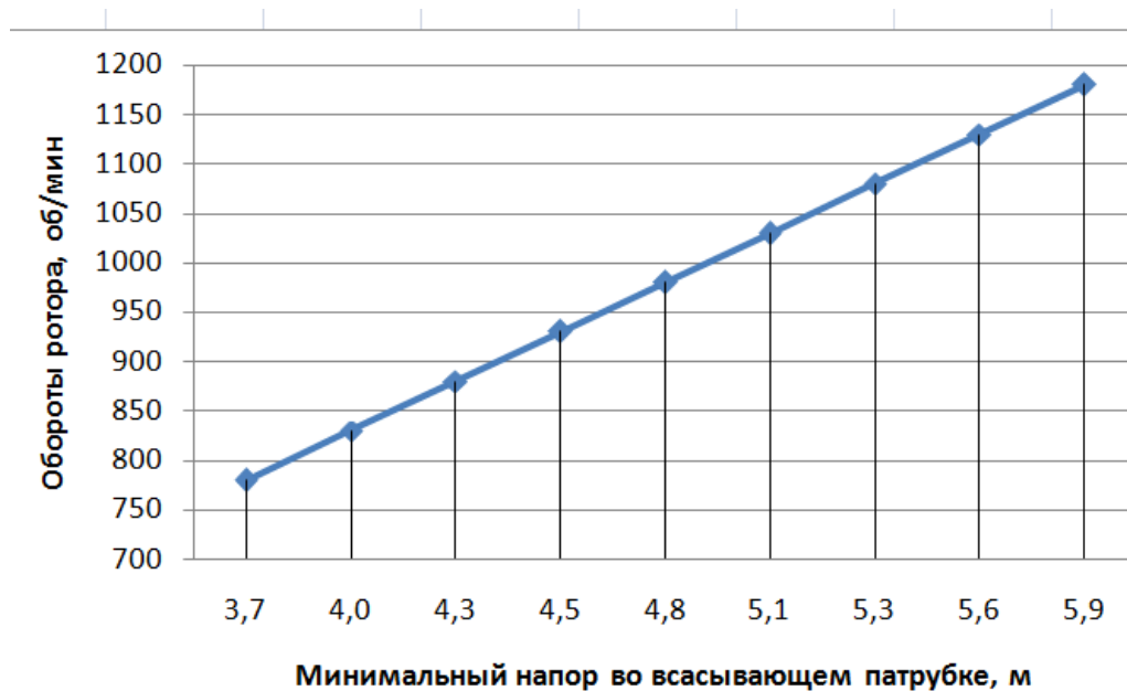
Рис. 5. Зависимость давления во всасывающей патрубке от оборотов ротора
