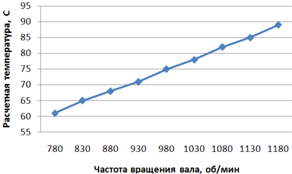
Рис. 4. График зависимости температуры подшипников от оборотов ротора
