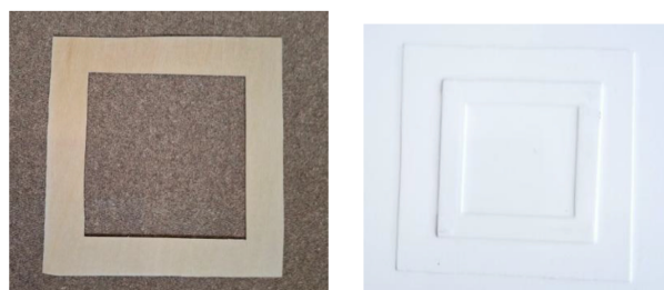
Рис. 4. Щит с фигурной накладкой из ДВП: a – до облицовывания; б – после облицовывания Fig. 4. A shield with a curly fiberboard overlay: a – before cladding; б – after cladding
