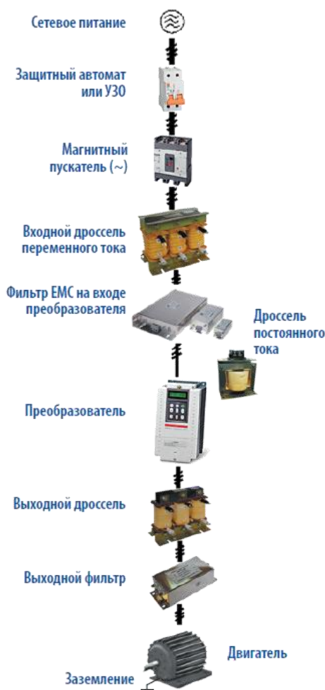
Рис. 7. Силовая схема включения ПЧ
