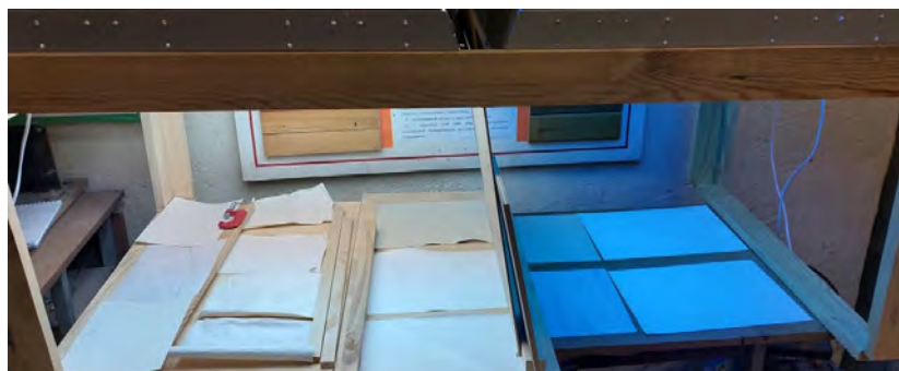
Рис. 1. Установка для облучения ЗДП (пленок ПВХ) люминисцентными (слева) и УФ-лампами (справа)
