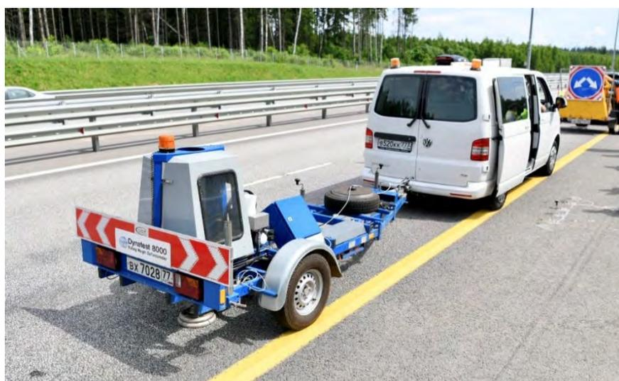
Рис. 1. Установка динамического нагружения падающим грузом
