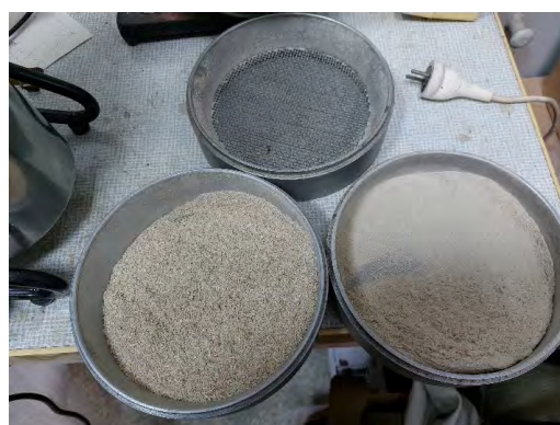
Рис. 4. Разделение древесной муки на фракционный состав при просеивании через сита 0,75, 0,6, 0,43, 0,25 и < 0,25
