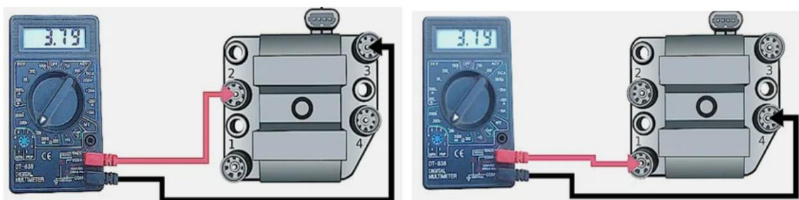
Рис. 4.9. Проверка модуля зажигания на обрыв
