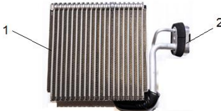
Рис. 3.11. Испаритель КУ: 1 – теплообменник; 2 – ТРВ
