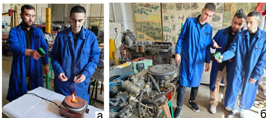
Рис. 1.5. Работа с пирометром в лаборатории кафедры ТС: а – определение температуры вспышки ДТ; б – замер температуры выпускного коллектора двигателя
