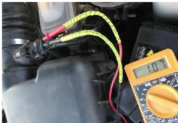
Рис. 4.4. Подключение мультиметра при проверке ДМВР
