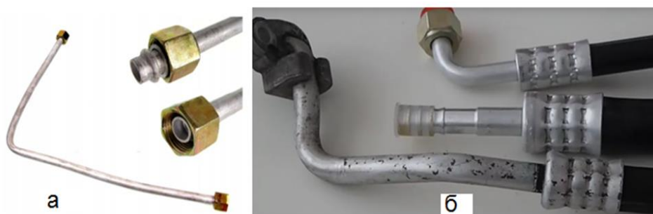
Рис. 3.16. Магистрали высокого (а) и низкого (б) давления
