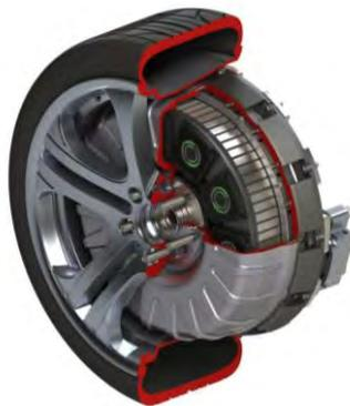
Рис. 3.4. Электромотор-колесо
