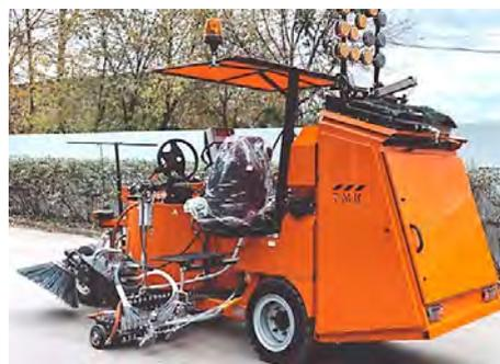
Рис. 304. Разметочная машина МДР-5 Т750 (термопластик)
