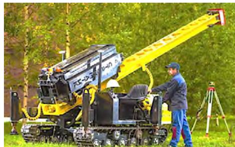
Рис. 316. Сваебойная установка
