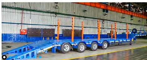
Рис. 251. Низкорамный полуприцеп (трал) НЕФАЗ-93344
