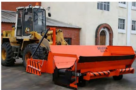
Рис. 285. Машина для отсыпки обочин БЦМ-73
