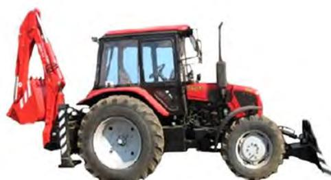
Рис. 145. Экскаватор-бульдозер ЭБП 11.3 на базе трактора Беларус 92П.4
