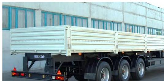
Рис. 236. Полуприцеп бортовой
