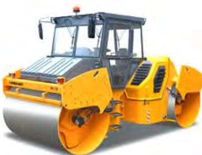
Рис. 88. Каток вибрационный с гладкими вальцами RV-14,0 DD
