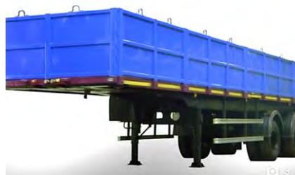
Рис. 244. Полуприцеп бортовой
