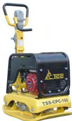
Рис. 104. Виброплита гидравлическая
