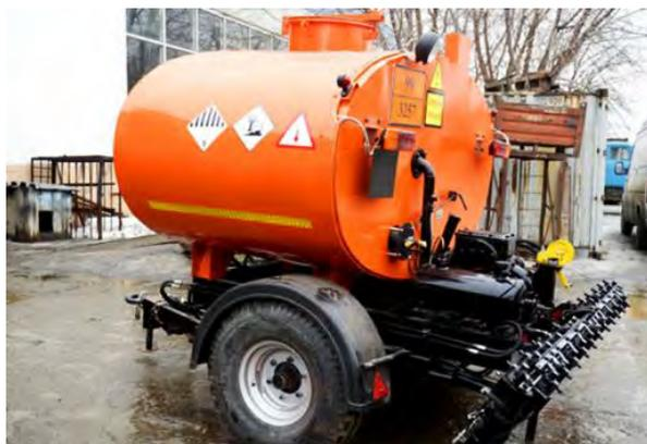
Рис. 167. Автогудронатор прицепной УСМ ОГП-2 (2 м<sup>3</sup>) для трактора МТЗ-82 и др.
