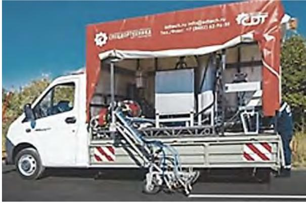
Рис. 295. Разметочная машина
