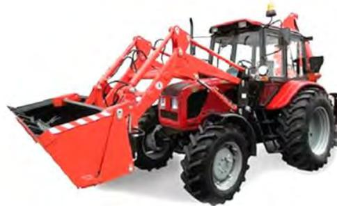
Рис. 149. Экскаватор-погрузчик ЭО 2626С-1, на базе трактора Беларус 92П.4
