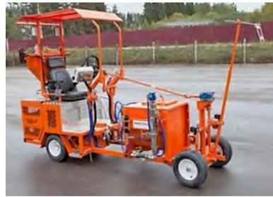
Рис. 298. Самоходная разметочная машина «Виннер» СМ-122
