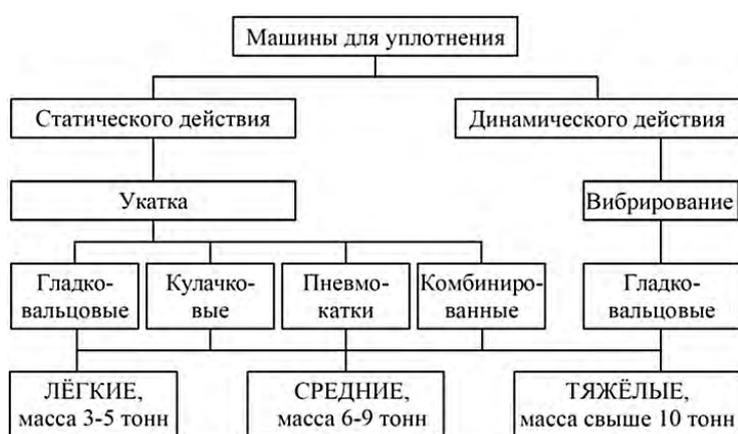
Рис. 67. Классификация машин для уплотнения
