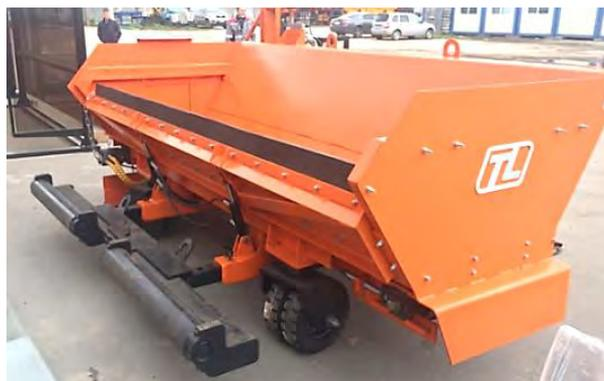
Рис. 286. Отсыпщик обочин УКБ200
