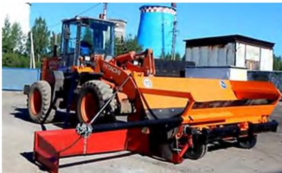
Рис. 289. Отсыпщик (укладчик) обочин УСМ 2.2А
