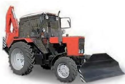
Рис. 146. Экскаватор-бульдозер ЭБП 9.3 на базе трактора МТЗ-82.1
