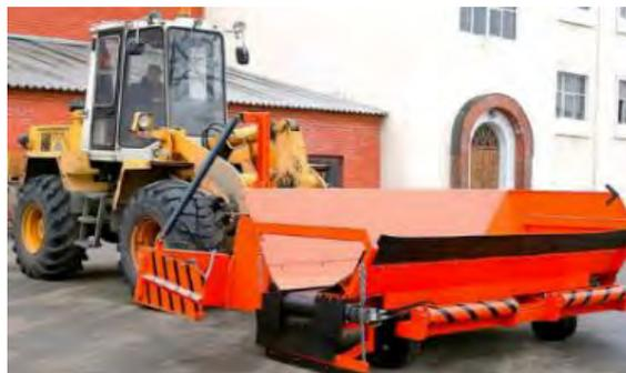
Рис. 292. Укладчик обочин СДМ.ЩРН
