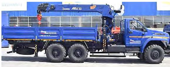
Рис. 277. Бортовой УРАЛ NEXT 4320-6952-72Е5Г38 с КМУ АНТ 20-5ТЛ (большой выбор по другим характеристикам)
