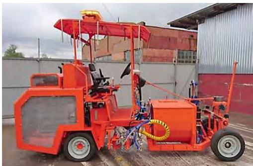
Рис. 299. Самоходная разметочная машина «Виннер» СМ-522С
