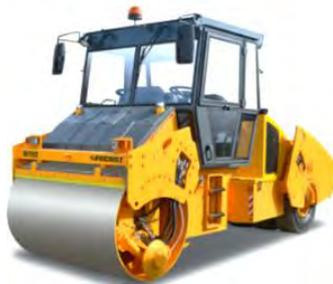
Рис. 86. Каток вибрационный комбинированный RV-11,0 DS
