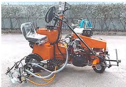
Рис. 307. Разметочная машина МР К65 (краска)
