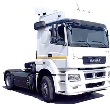
Рис. 208. Седельный тягач, газодизельный
