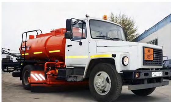
Рис. 168. Автогудронатор УСМ ОГ-4С на базе ГАЗ 3309
