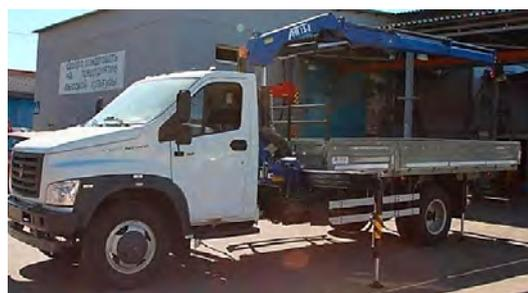
Рис. 280. Бортовой ГАЗон NEXT С41R с КМУ АНТ 7.5-2
