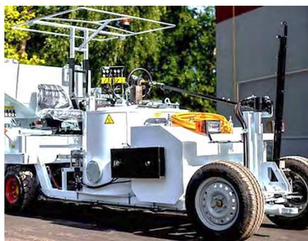
Рис. 303. Разметочная машина МДР-5 ТК550 (двухкомпонентные термопластик и краска)
