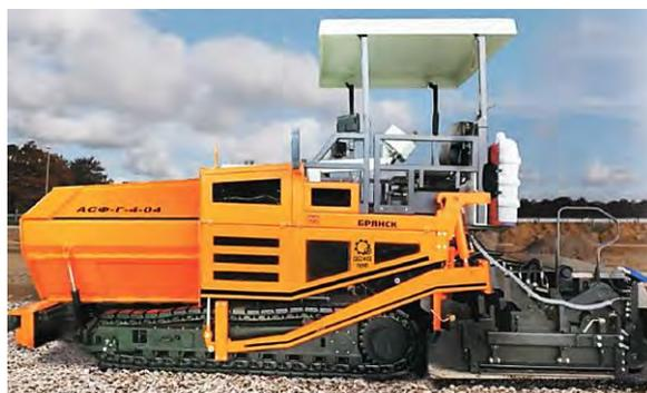
Рис. 171. Гусеничный асфальтоукладчик АСФ-Г-4-04 с газовым обогревом
