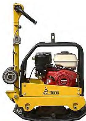
Рис. 103. Виброплита гидравлическая
