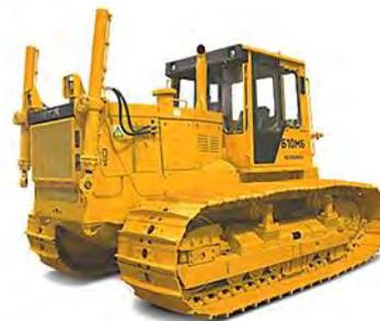
Рис. 40. Бульдозер Б10МБ (болотоходный)
