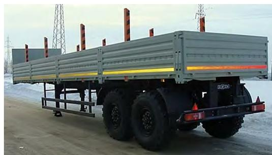
Рис. 238. Полуприцеп бортовой
