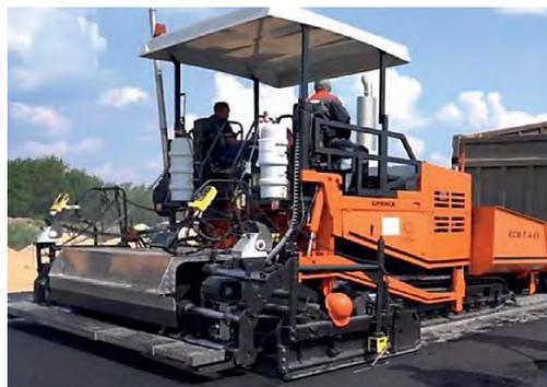
Рис. 173. Гусеничный асфальтоукладчик АСФ-Г-4-05 с газовым обогревом
