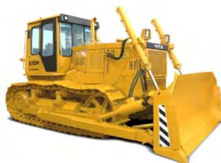
Рис. 32. Бульдозер Б10М (ГМТ)
