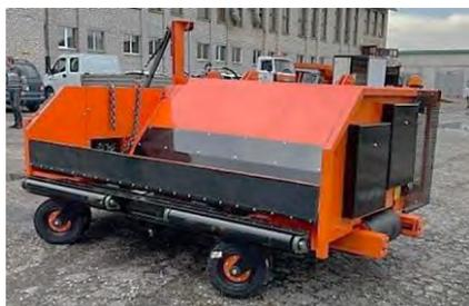
Рис. 281. Укладчик обочин МКД-1000М
