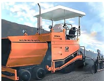
Рис. 178. Колесный асфальтоукладчик АСФ-К-2-07-1 с газовым обогревом
