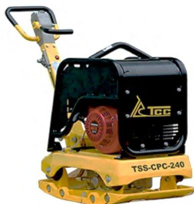
Рис. 106. Виброплита гидравлическая реверсивная, бензиновая TSS-CPC-240
