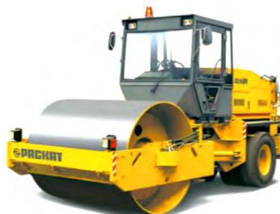
Рис. 85. Каток вибрационный комбинированный ДУ-84
