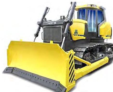
Рис. 34. Бульдозер Б11
