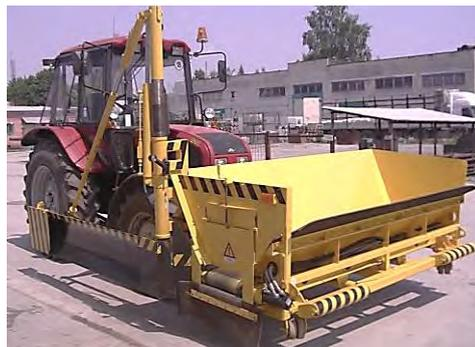
Рис. 290. Отсыпщик обочин ОНУ-2300
