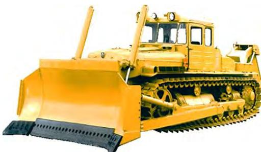
Рис. 47. Бульдозерно-рыхлительный агрегат ДЭТ-250М2
