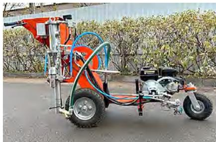
Рис. 308. Разметочная машина МР К20 (краска)
