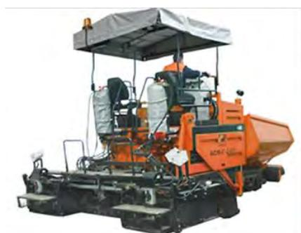
Рис. 174. Гусеничный асфальтоукладчик АСФ-Г-2-01 с газовым обогревом
