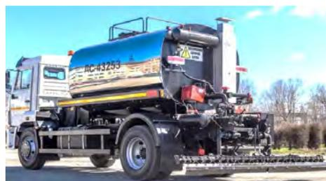
Рис. 159. Автогудронатор ДС-43253 на шасси автомобиля КАМАЗ-43253
