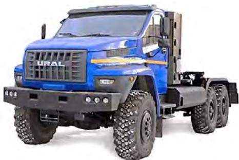
Рис. 215. Седельный тягач, УРАЛ CNG 44202-5911-16, 6×6
