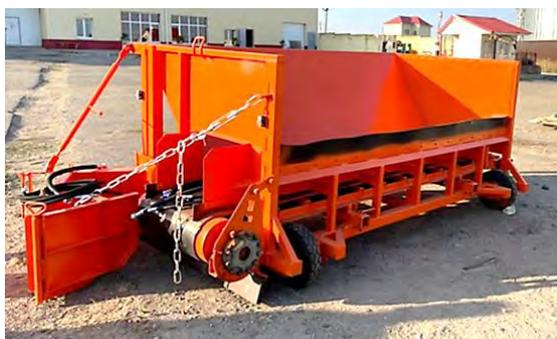
Рис. 287. Отсыпщик (укладчик) обочин УСМ 2.0
