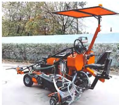
Рис. 305. Разметочная машина МДР-5 Т250 (термопластик)
