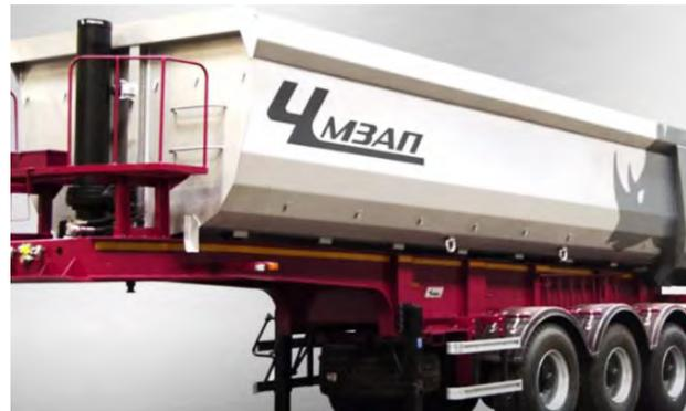
Рис. 230. Полуприцеп ЧМЗАП 95201
