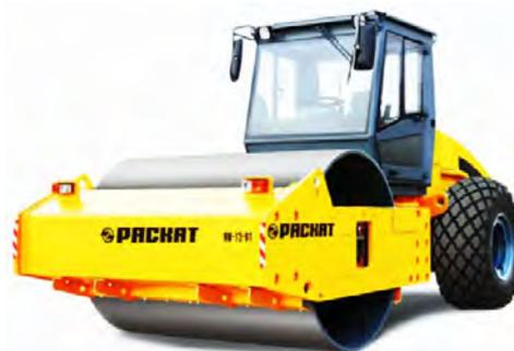
Рис. 79. Вибрационный грунтовый каток RV-13 DT
