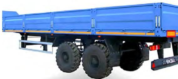
Рис. 243. Полуприцеп бортовой
