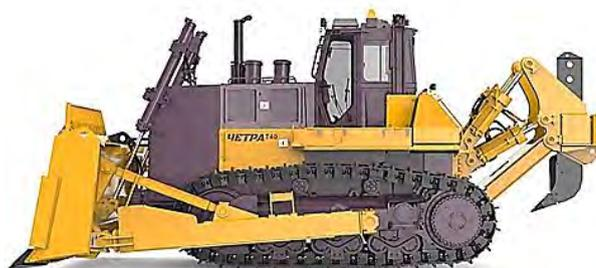
Рис. 44. Бульдозер «Четра» Т40
