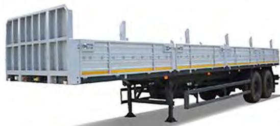
Рис. 240. Полуприцеп бортовой
