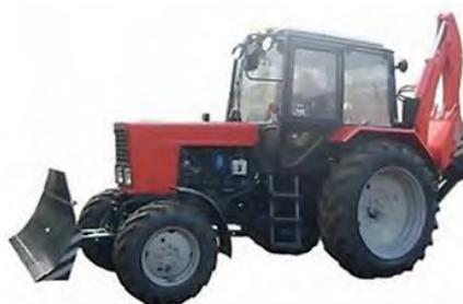
Рис. 147. Экскаватор-бульдозер ЭБП 9.4 на базе трактора Беларус 92П.4
