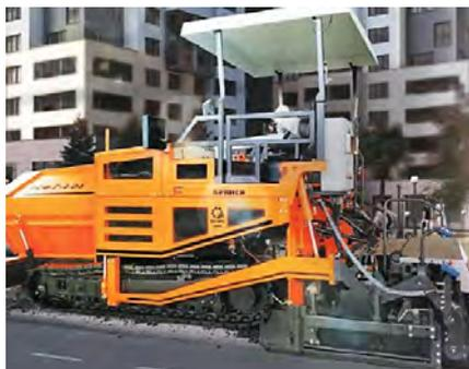
Рис. 172. Гусеничный асфальтоукладчик АСФ-Г-4-04 с электрообогревом
