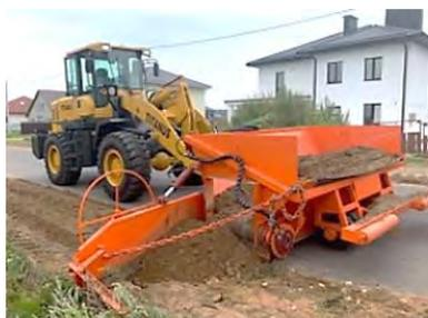
Рис. 283. Укладчик обочин МК-2000 на погрузчик фронтальный
