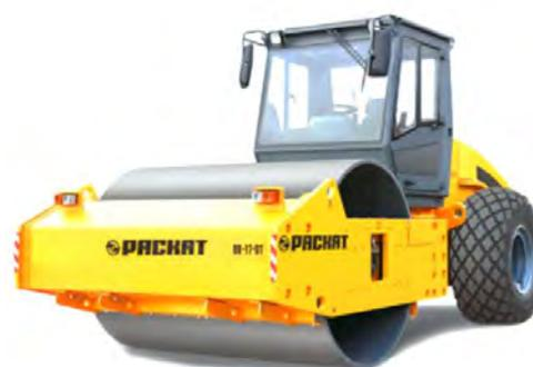
Рис. 81. Вибрационный грунтовый каток RV-17 DT
