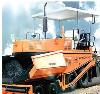
Рис. 177. Колесный асфальтоукладчик АСФ-К-4-02-2 с газовым обогревом
