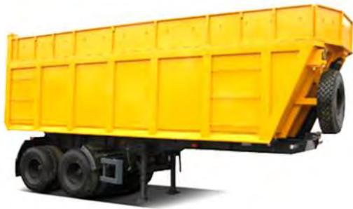
Рис. 227. Полуприцеп
