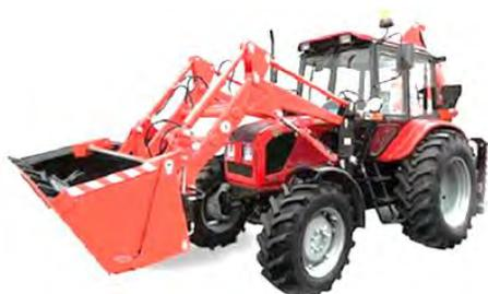
Рис. 144. Экскаватор-погрузчик ЭБП 11.1 на базе трактора Беларус 92П.4
