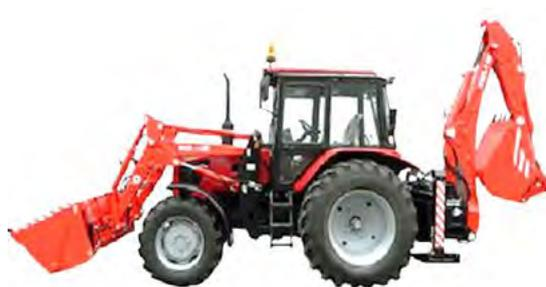
Рис. 143. Экскаватор-погрузчик ЭБП 11М на базе трактора Беларус 92П.4
