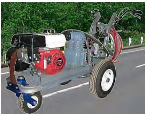
Рис. 293. Ручная разметочная машина СДТ
