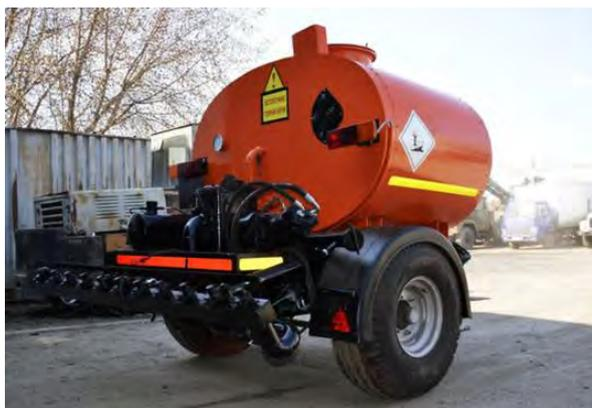
Рис. 166. Автогудронатор прицепной УСМ ОГП-1,2 (1,2 м<sup>3</sup>) для трактора МТЗ-82 и др.
