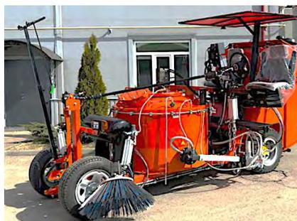
Рис. 302. Разметочная машина МДР-5 ТС550 (термопластик/спрей-пластик)
