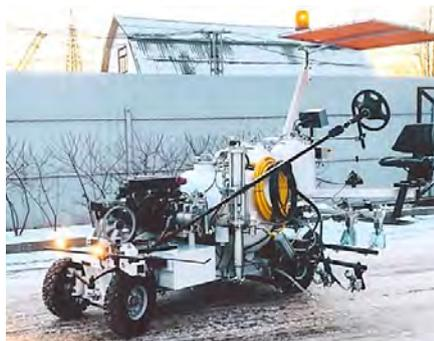
Рис. 306. Разметочная машина МДР-5 К300 (краска)
