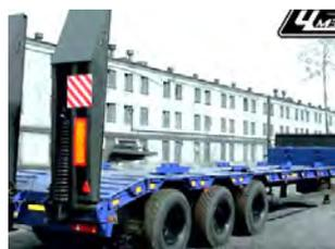
Рис. 253. Полуприцеп-тяжеловоз автомобильный (среднерамный) ЧМЗАП 99064 по спецификации 076 КУ41
