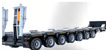
Рис. 252. Низкорамный полуприцеп-тяжеловоз ЧМЗАП 99905 по спецификации 020
