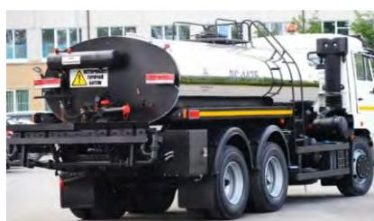
Рис. 161. Автогудронатор ДС-142Б на шасси автомобиля КАМАЗ-65115
