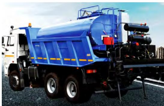
Рис. 162. Автогудронатор ИС на шасси автомобиля КАМАЗ самосвал
