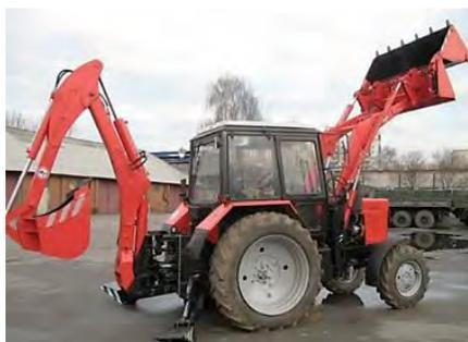
Рис. 142. Экскаватор-погрузчик ЭБП-9 на базе трактора МТЗ-82.1
