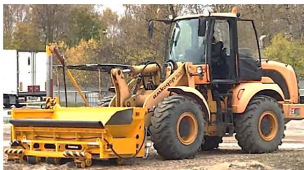
Рис. 288. Отсыпщик (укладчик) обочин УСМ 2.1
