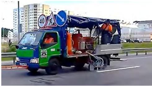
Рис. 297. Магистральная разметочная машина «Виннер» А622
