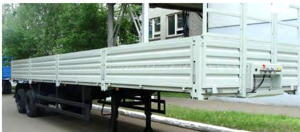
Рис. 235. Полуприцеп бортовой
