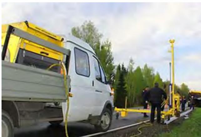
Рис. 309. Сваебойная установка КОПРА® серии ППМ 4-150
