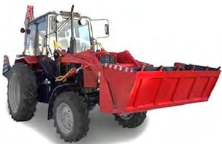
Рис. 148. Экскаватор-погрузчик ЭО 2626М, на базе трактора Беларус 92П.4
