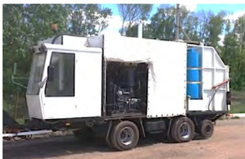
Рис. 301. Машина дорожная демаркировочная МДД-01 с гидравлическим приводом хода
