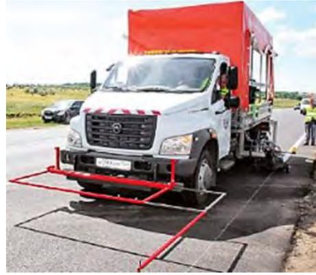
Рис. 296. Разметочная машина
