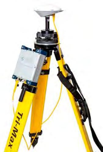
Рис. 14. Базовый комплект «ФАЗА2». RTK база ФАЗА 2 + ADL Vantage 35W
