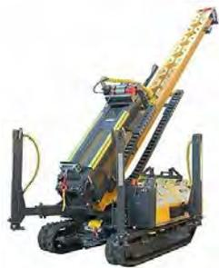
Рис. 315. Сваебойная установка
