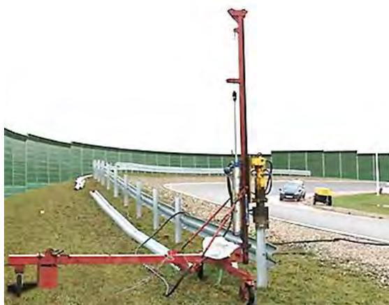
Рис. 310. Сваебойная установка КОПРА® серии ППМ 5-150
