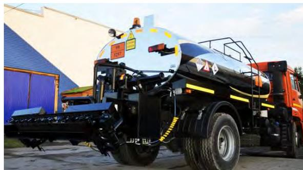
Рис. 169. Автогудронатор УСМ ОГ-5С на базе шасси КАМАЗ 4308
