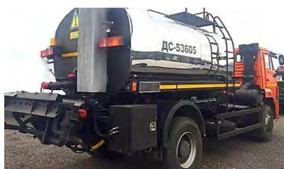
Рис. 160. Автогудронатор ДС-53605 на шасси автомобиля КАМАЗ-53605
