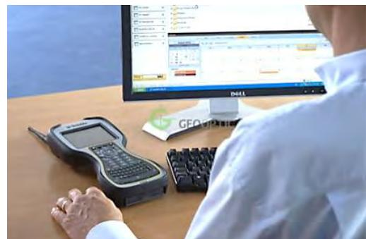
Рис. 19. Контроллер Trimble TSC3
