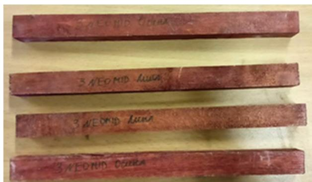
Рис. 3. Внешний вид древесины липы и осины, обработанной раствором на основе препарата NEOMID
