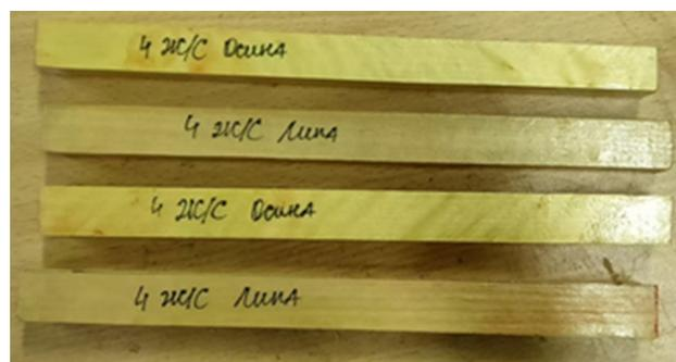
Рис. 4. Внешний вид древесины липы и осины, обработанной жидким стеклом
