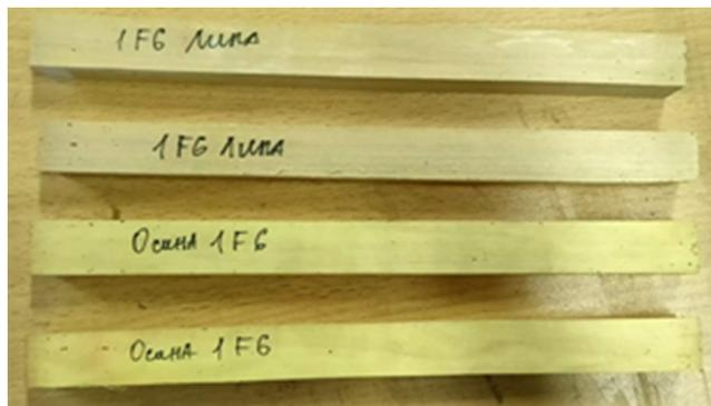
Рис. 1. Внешний вид древесины липы и осины, обработанной раствором на основе препарата UpGUARD F6
