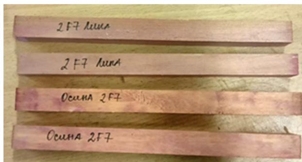
Рис. 2. Внешний вид древесины липы и осины, обработанной раствором на основе препарата UpGUARD F7
