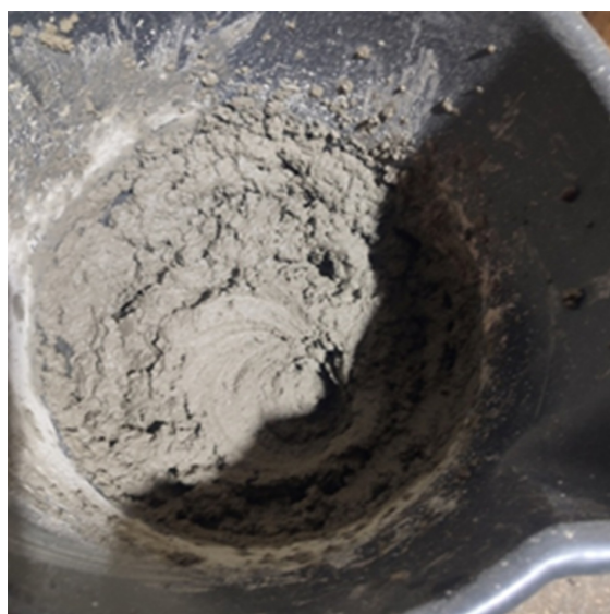
Рис. 5. Смесь после перемешивания и заполненные металлические формы Fig. 5. Mixture after mixing and filled metal molds
