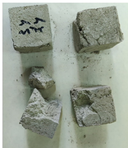
Рис. 6. Измерение массы, теплопроводности и прочности образцов Fig. 6. Measurement of mass, thermal conductivity and strength of samples
