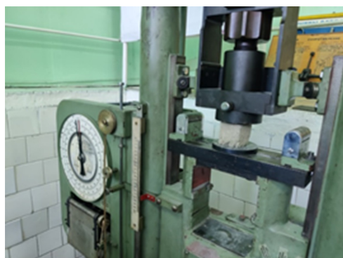
Рис. 6. Измерение массы, теплопроводности и прочности образцов Fig. 6. Measurement of mass, thermal conductivity and strength of samples
