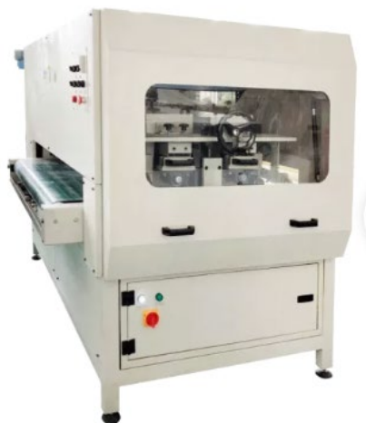
Рис. 3. Щеточный обеспыливающий станок DUST CLEANER-1300
