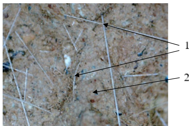
Рисунок 13 – Изображение структуры фиброцементогрунта в возрасте 28 суток твердения: 1 – стеклянные волокна; 2 – цементогрунтовая матрица
