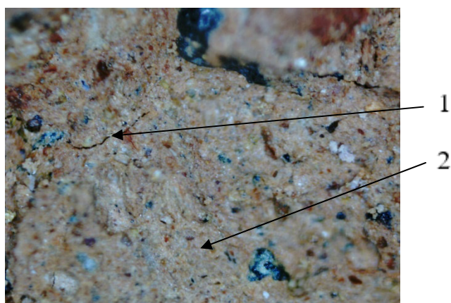
Рисунок 12 – Изображение структуры цементогрунта в возрасте 28 суток твердения: 1 – микротрещина; 2 – цементогрунтовая матрица
