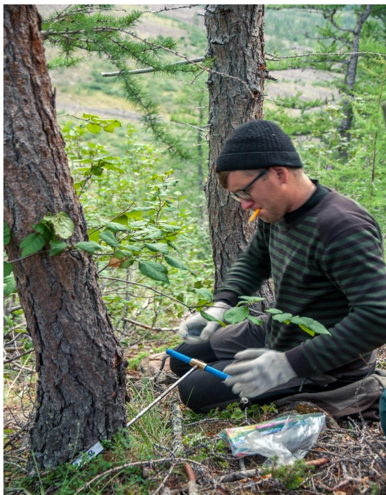
Рисунок 3.4. – Отбор образцов (кернов) древесины возрастным буравом
