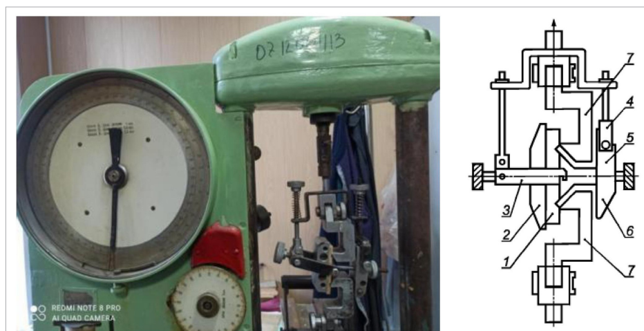
Рис. 7. Испытательная машина (слева) и приспособление (справа) для определения предела прочности фанеры при скалывании:
