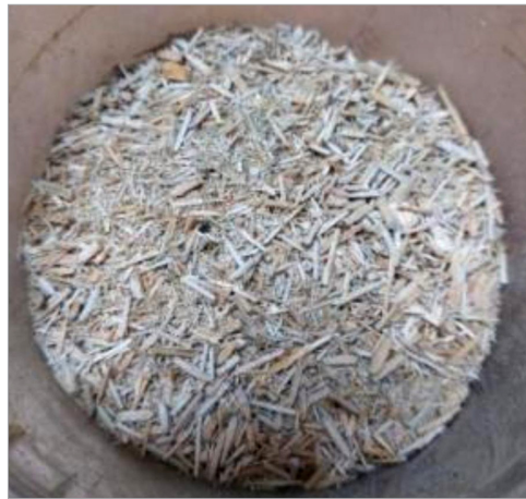
Рис. 2. Измельченные в молотковой мельнице обрезки фанеры Fig. 2. Plywood clippings crushed in a hammer mill
