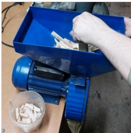
Рис. 1. Молотковая мельница «ЗУБР-1С» Fig. 1. Hammer mill “ZUBR-1С”
