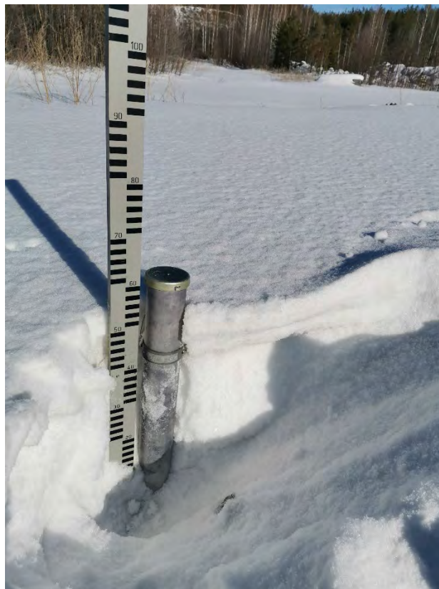
Рис. 14. Снегомерная рейка (слева) и снегомер весовой БС-43 (справа)
