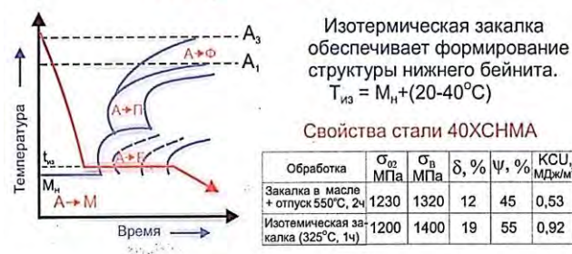
Рис. 43. Диаграмма распада переохлажденного аустенита
