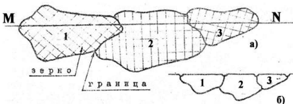
Рис. 18. Схематическое увеличенное изображение поверхности: а – неполированного образца; б – микрошлифа после полировки и травления; MN – плоскость шлифа, выше которой был снят слой металла полировкой
