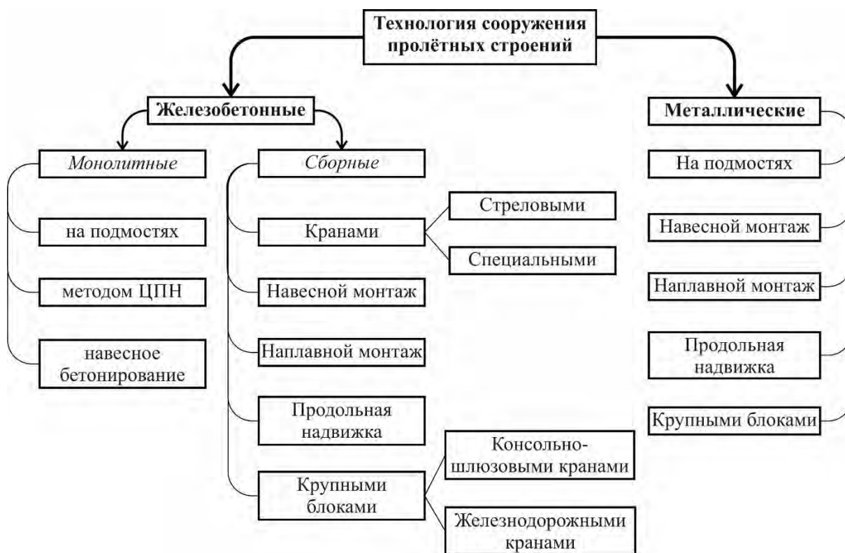
Рис. 1.2. Технологии сооружения пролётных строений мостов (ЦПН – цикличная продольная надвижка)
