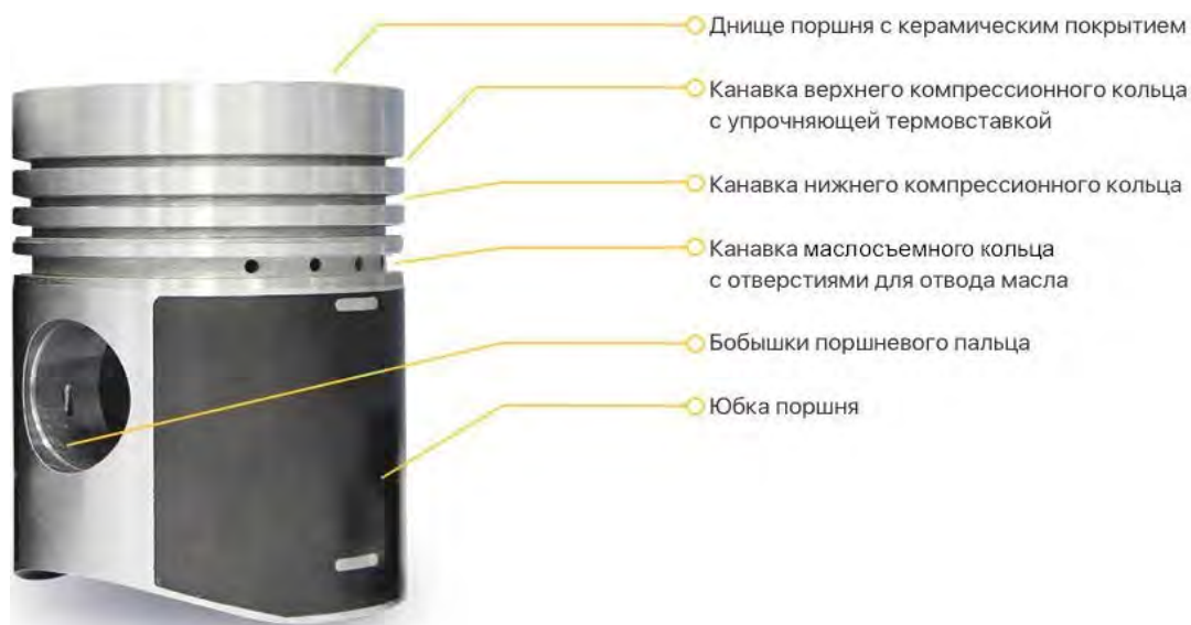
Рис. 1. Составляющие поршня ДВС [1]
