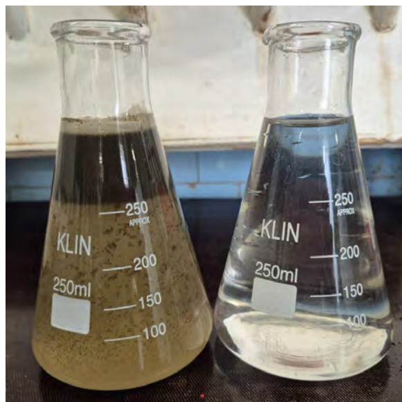
Рис. 2. Пробы до и после очистки препаратом «Праестол»
