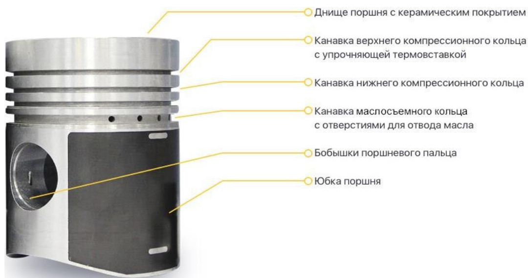
Рис. 1. Составляющие поршня ДВС [1]
