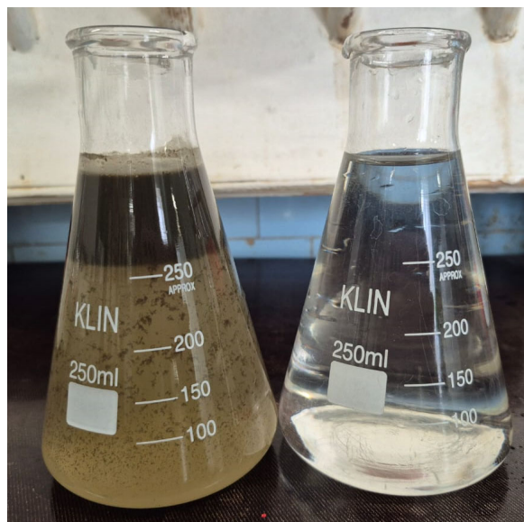
Рис. 2. Пробы до и после очистки препаратом «Праестол»
