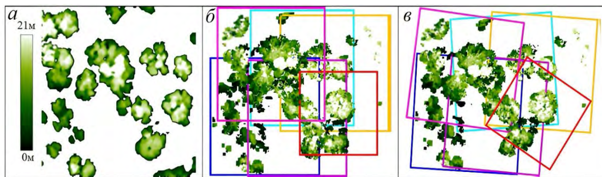
Рис. 129. Пример регистрации наземных сканов в системе координат данных бортового лидара. Для одной и той же лесной площади отображается ложное цветное представление модели высоты полога для: а – данных бортового лидара; б – объединения исходных сканирований наземных лидаров; в – объединения зарегистрированных сканирований наземных лидаров. Для каждого сканирования наземного лидара вычисляется наилучшее евклидово преобразование, чтобы оно соответствовало горизонтальной структуре полога, представленной в данных бортового лидара [A novel automatic method for the fusion of ALS and TLS LiDAR data for robust assessment of tree crown structure, 2017]
