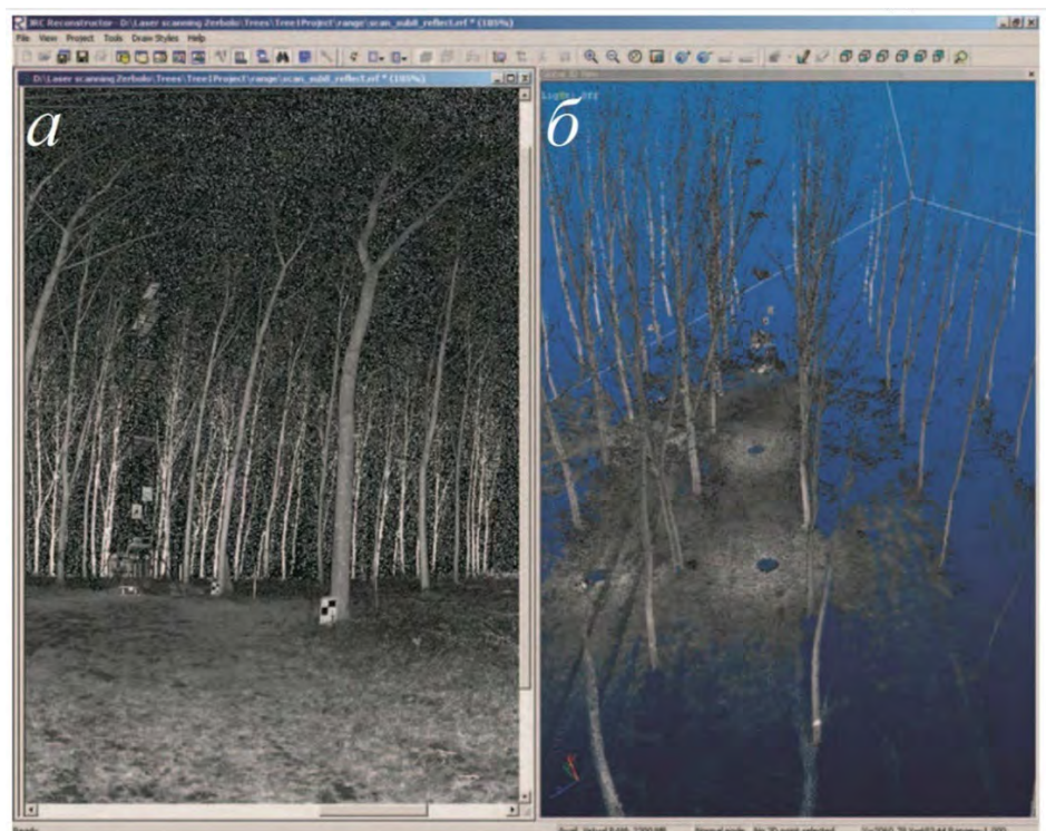
Рис. 106. Исходные данные, полученные в результате лазерного сканирования, представлены в виде: а – изображения отражающих мишеней, позиционированных до измерений на участке; б – общего трехмерного изображения, сканирование расстояний на котором было выполнено в четырех разных точках вокруг каждого дерева; отверстия, видимые на б , представляют положение лазера во время сканирования [Building a topological and geometrical model of poplar tree using portable on-ground scanning LIDAR, 2008]
