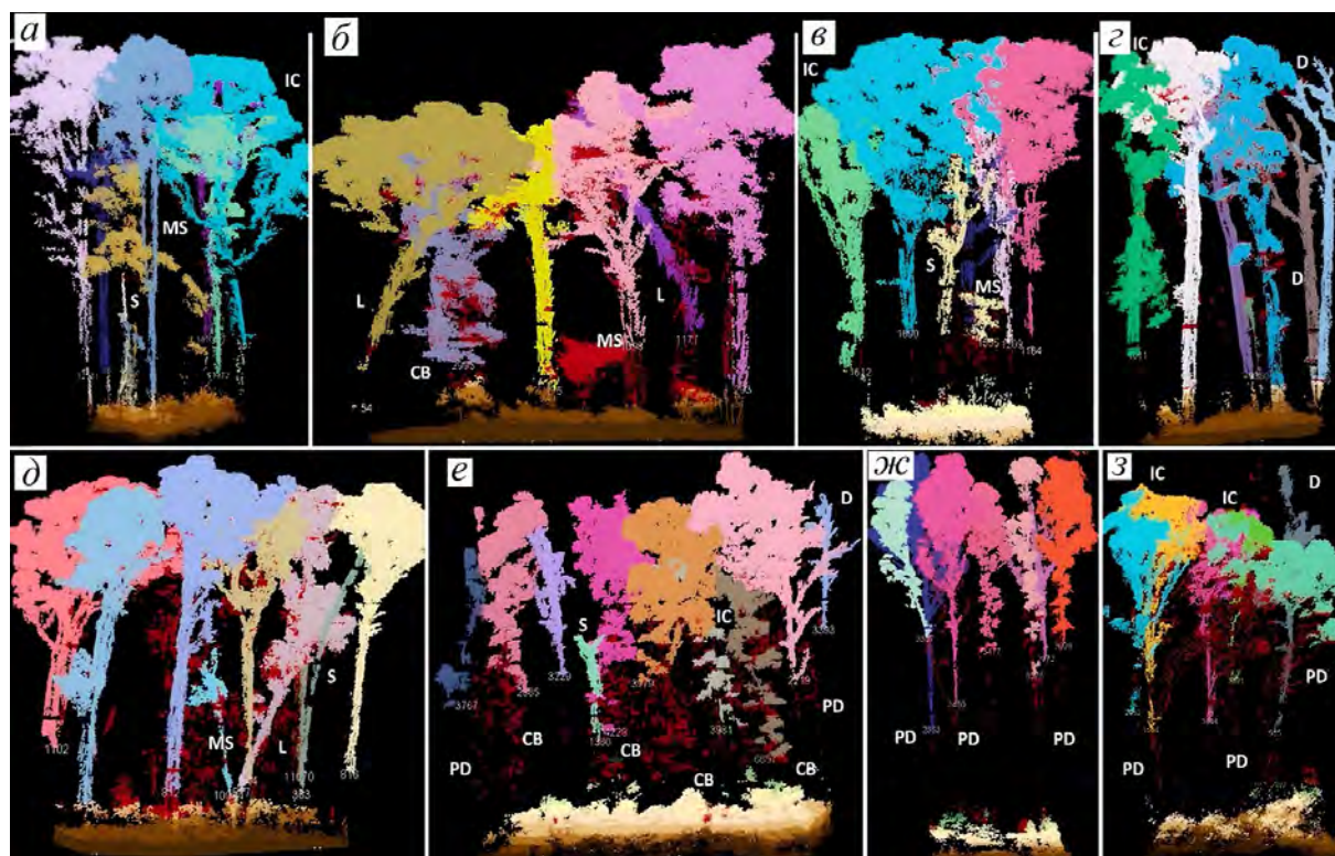
Рис. 98. Пример сегментации деревьев с типичными лесными условиями с использованием красного цвета для обозначения неклассифицированных точек низкой плотности, коричнево-зеленой цветовой шкалы для обозначения точек нижнего яруса и всех остальных цветов для обозначения обнаруженных деревьев: а – переплетающийся полог (IC), а также подавленные (S) и деревья среднего яруса (MS); б – наклоненные деревья (L) и соприкосновения основания кроны верхнего яруса с нижним ярусом (CB) и (MS); в – деревья IC, S и MS; з – деревья IC и сухостойные (D); д – деревья MS, L и S; е–з – снижение плотности точек по профилю полога (PD) в условиях CB, S, D и IC [Individual tree detection and crown delineation from unmanned aircraft system (UAS) LiDAR in structurally complex mixed species eucalypt forests, 2021]
