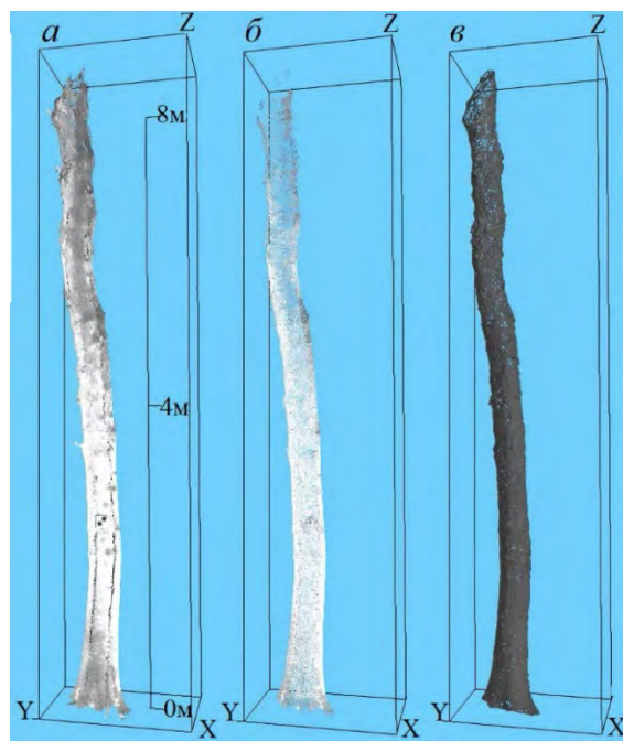
Рис. 105. Триангуляция точек дерева с помощью алгоритмов «силовой корки»: a – облако точек дуба в количестве 800 000 точек; б – облако точек, уменьшенное до 50 000 точек сканирования; в – сгенерированная триангуляция [Aschoff, Thies, Spiecker, 2004]
