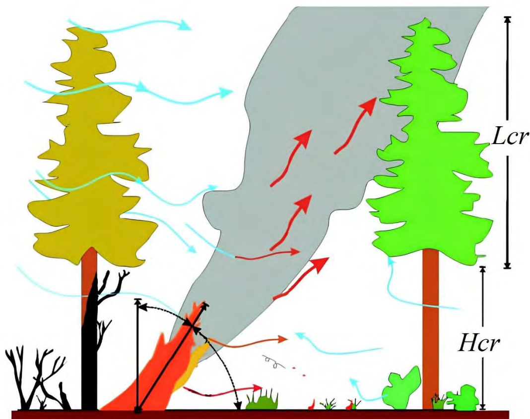
Рис. 132. Схема возникновения верхового пожара (Alexander, Cruz, 2011; 2012)
