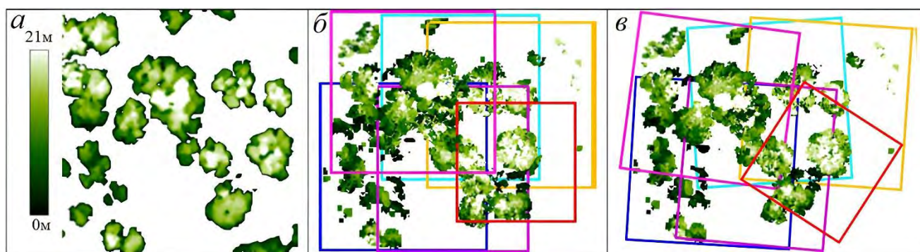
Рис. 129. Пример регистрации наземных сканов в системе координат данных бортового лидара. Для одной и той же лесной площади отображается ложное цветное представление модели высоты полога для: a – данных бортового лидара, б – объединения исходных сканирований наземных лидаров и в – объединения зарегистрированных сканирований наземных лидаров. Для каждого сканирования наземного лидара вычисляется наилучшее евклидово преобразование, чтобы оно соответствовало горизонтальной структуре полога, представленной в данных бортового лидара (Paris et al., 2017)
