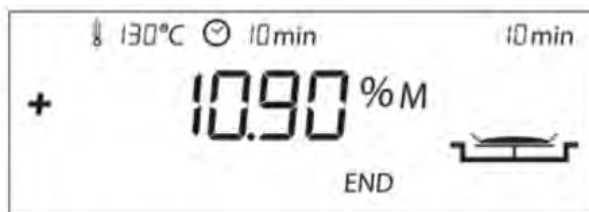
Рис. 4.5. Индикация дисплея электронного влагомера по завершении процесса высушивания
