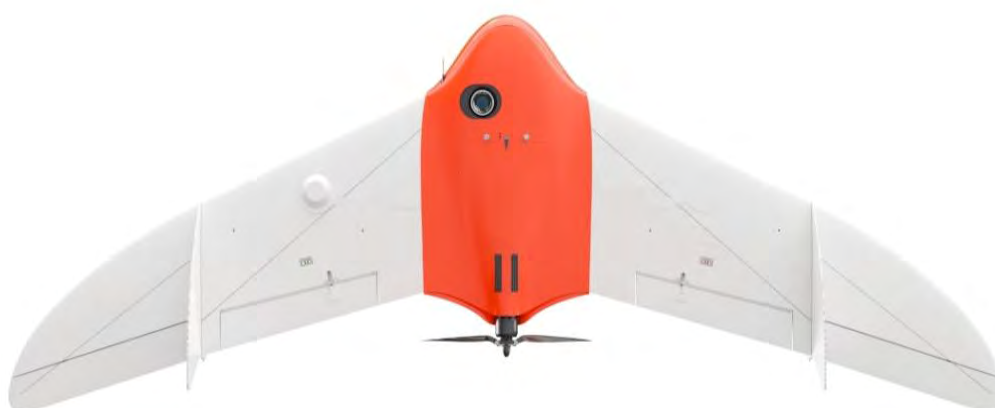
Рис. 2. Внешний вид БВС «Геоскан 201». Вид снизу [3]
