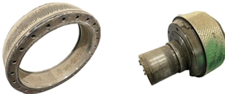
Рис. 3 Кольцевая матрица и прессующий ролик Fig. 3 Ring matrix and pressing roller
