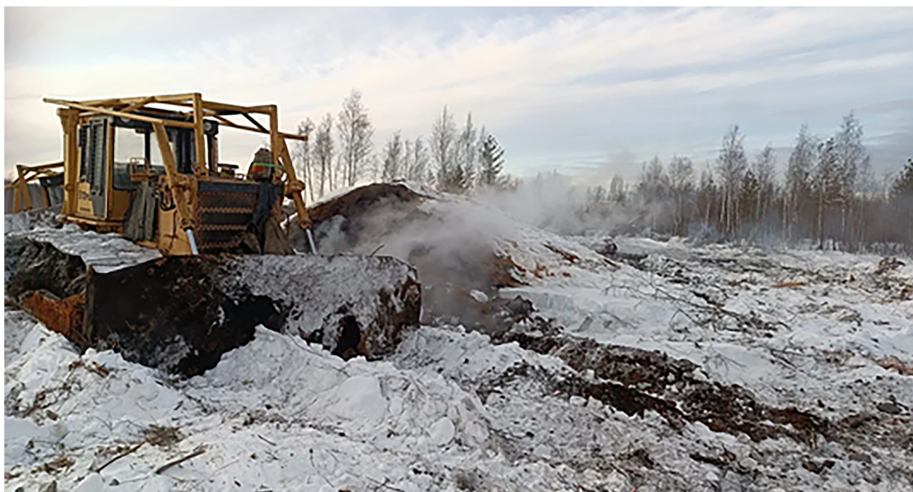
Рис. 10. Тушение горящего заброшенного каравана с применением бульдозеров в зимний период (Свердловская область)
