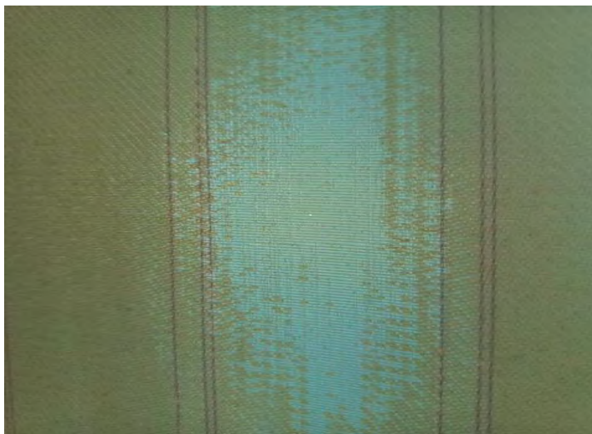
Рис. 1. Износ формирующей сетки БДМ
