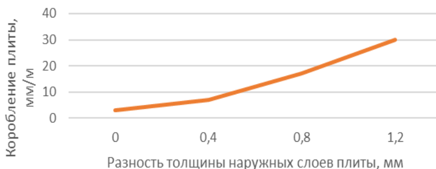
Рис. 3. Зависимость коробления плиты от разности толщины наружных слоев
