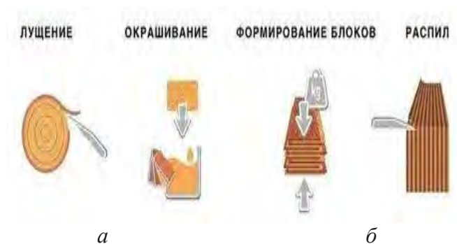
Рис. 1. Схема изготовления отделочных материалов из лущеного шпона мягколиственной древесины: а – склеивание чередующихся слоев в блоки; б – раскрой на листы
