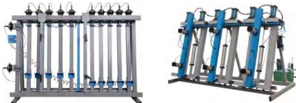
Рис. 2. Пневматическая и гидравлическая ваймы
