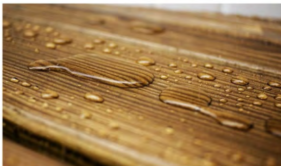
Рис. 1. Водоотталкивающий эффект покрытой маслом древесины
