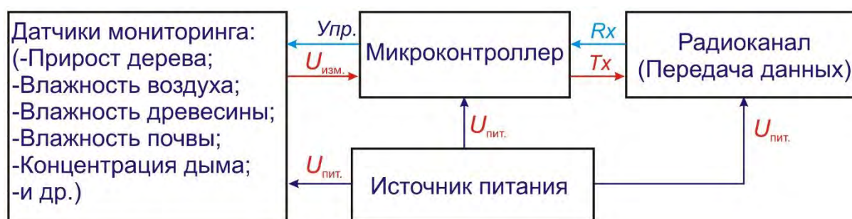
Рис. 2. Структурная схема измерительной системы в лесу
