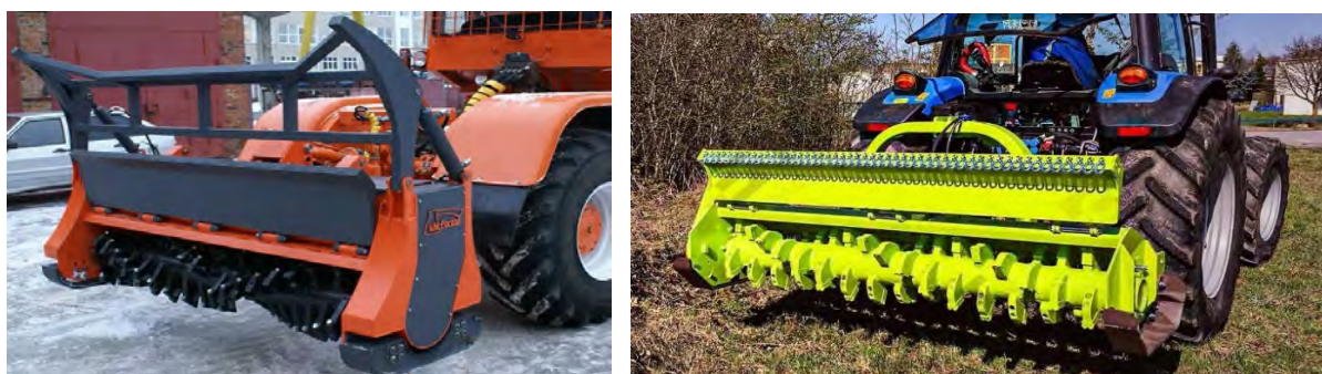
Рис. 3. Роторные мульчеры Caterpillar
