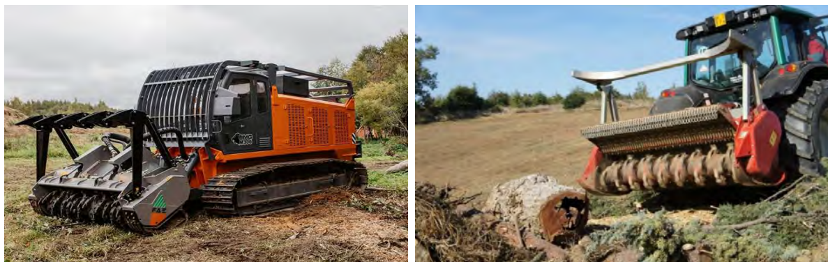
Рис. 1. Барабанные мульчеры Serpi M и Fescon
