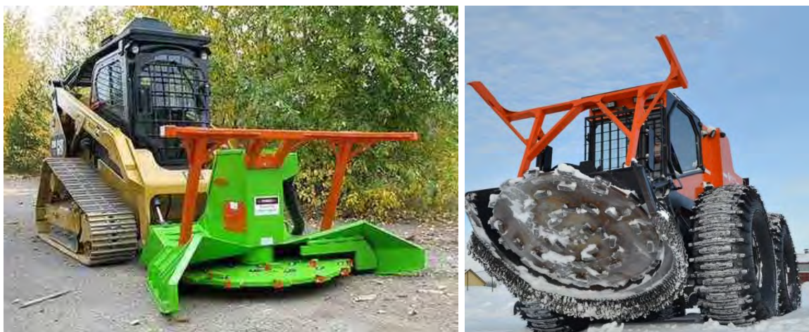
Рис. 2. Дисковые мульчеры Kuhn и John Deere
