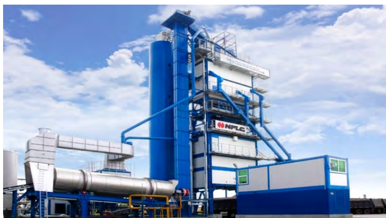
Рис. 4. Асфальтосмесительная установка с возможностью добавления резиновой крошки в горячий асфальтобетон
