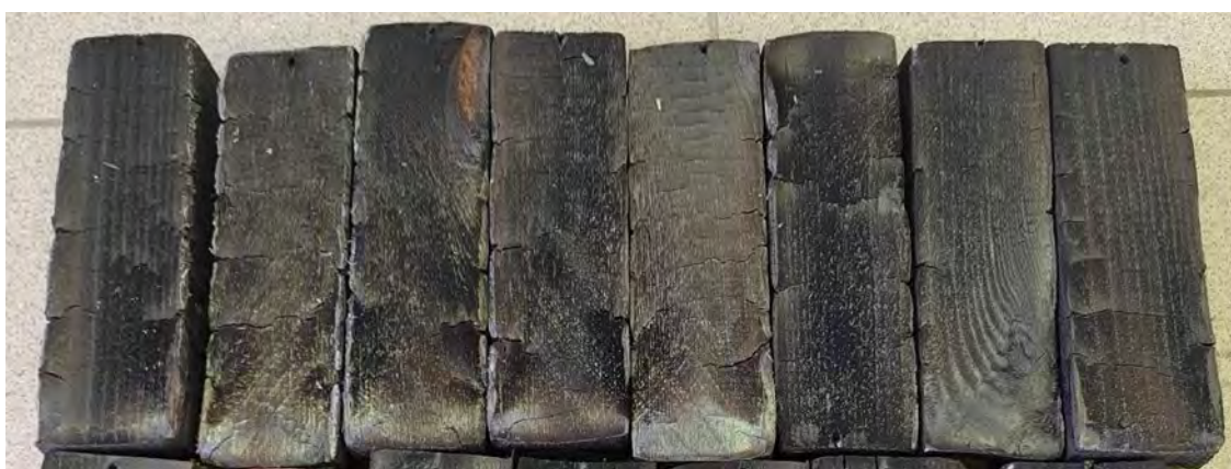
Рис. 2. Внешний вид образцов после испытаний на горючесть
