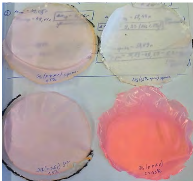
Пленочные дозиметры на основе ацетата целлюлозы и красителя «Родамин 6G»
