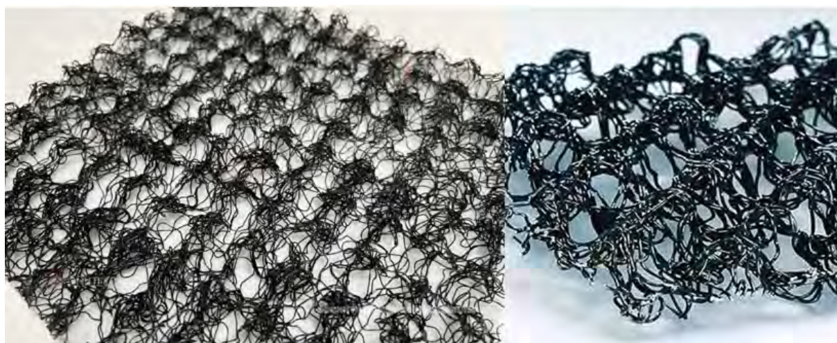
Рис. 3. Геомат: общий вид и структура
