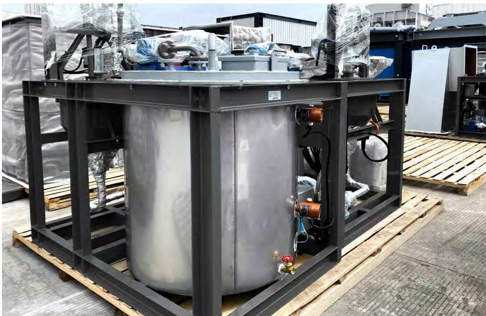
Рис. 1. Установка для дозирования адгезионных добавок
