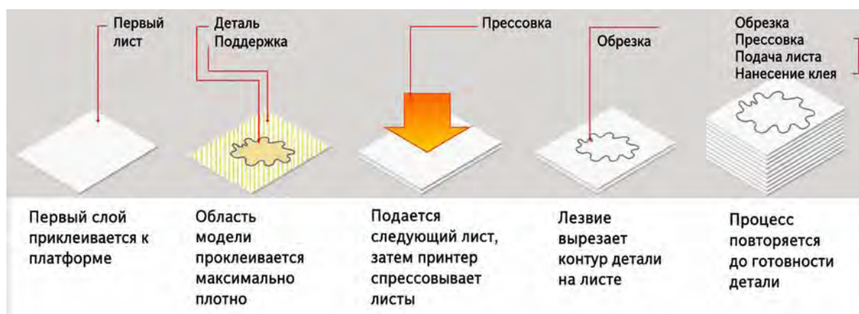
Рис. 3.5. Схема процесса ламинирования методом селективного осаждения
