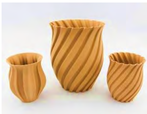
Рис. 6.17. Модели, полученные из ДПК-филамента 22
