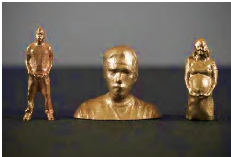
Рис. 6.19. Модели, полученные из филамента BronzeFill 24
