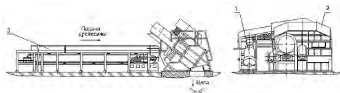
Рис. 2.8. Рубительная машина с наклонным диском: 1 – привод; 2 – механизм рубки; 3 – механизм подачи
