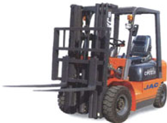
Рис. 11. Автопогрузчик с фронтальным расположением вилочных под-
