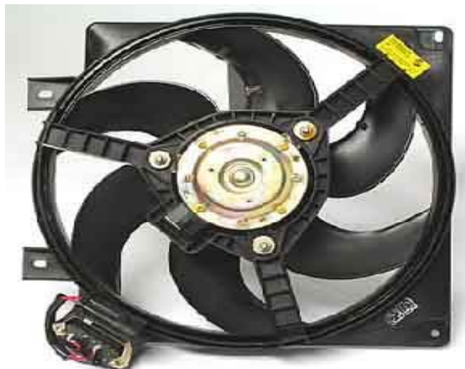
Рис. 25. Внешний вид вентилятора в системе охлаждения
