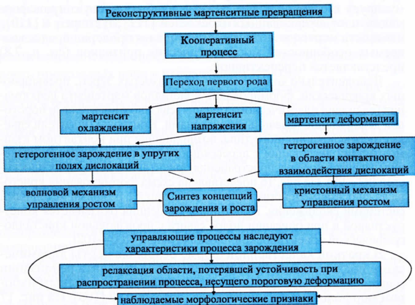
Рис. 17. Узловые моменты описания мартенситной реакции в моно- и поликристаллических материалах с размерами зерен, превышающими критический размер D_c
