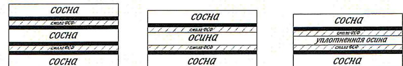
Рисунок 11 - Схемы сборки экспериментальных пакетов для склеивания
