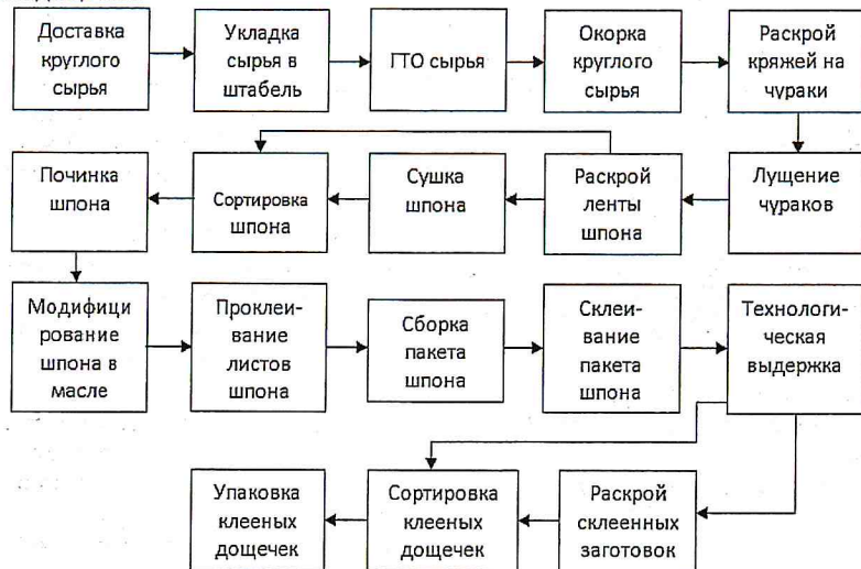
Рисунок 13 – Схема полного технологического процесса производства клееных карандашных дощечек на основе модифицированного шпона березы
