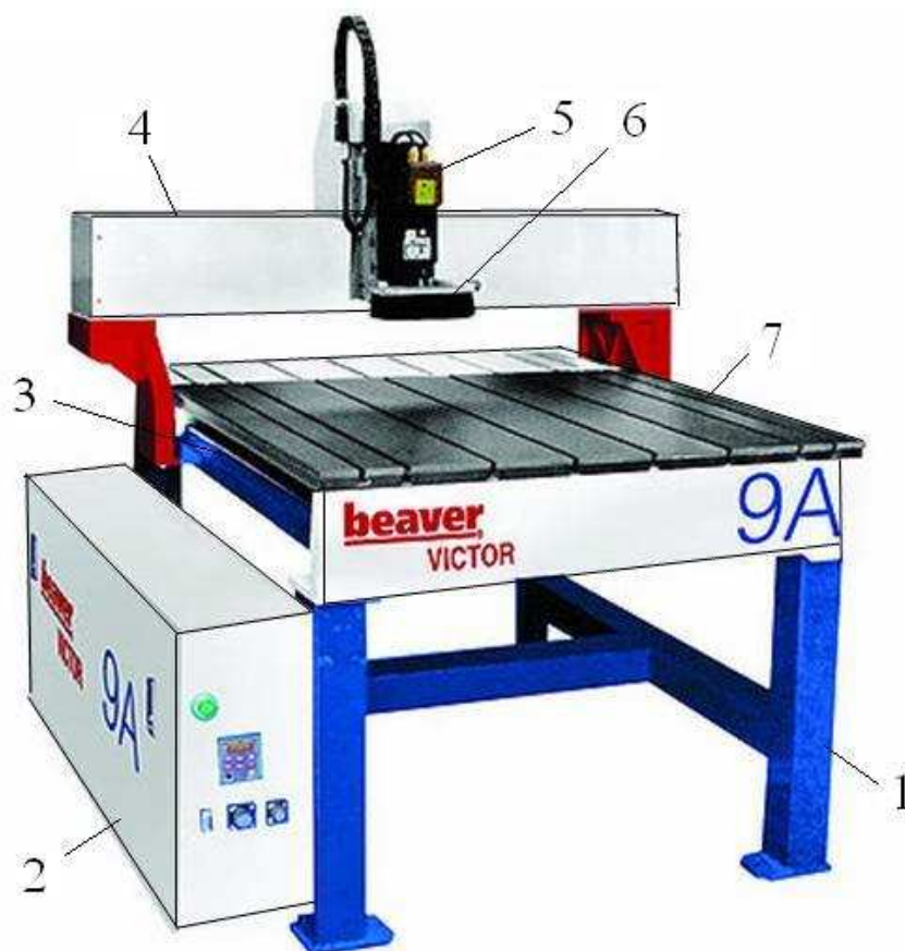
Рис. 1. Фрезерный станок с ЧПУ: 1 – рама; 2 – блок управления; 3 – продольные направляющие; 4 – портал; 5 – шпиндель механизма главного движения; 6 – ограждение-щетка для удаления стружек; 7 – стол
