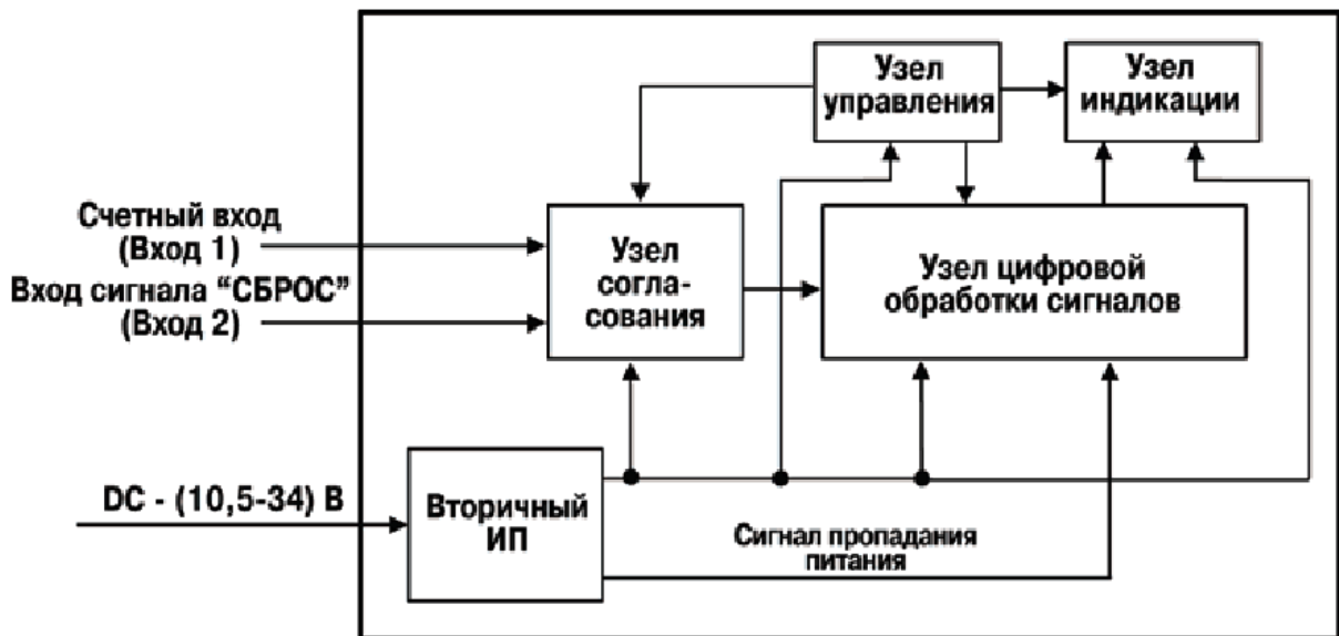
Рис. 10. Функциональная схема счетчика импульсов СИ10
